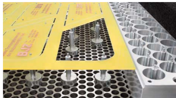
Detailaufnahme der Magnetstützen / detailed view of the magnet supports
