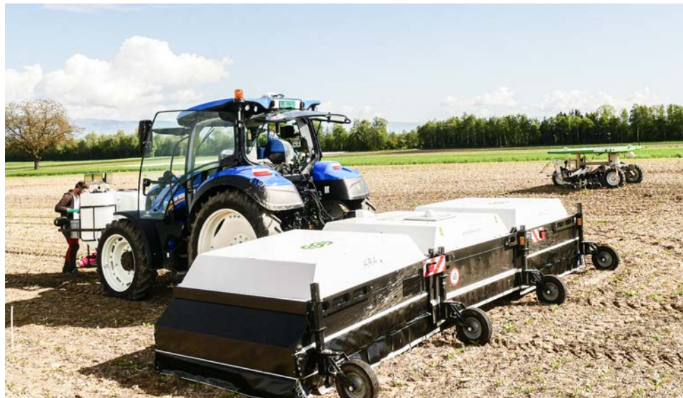
Der Roboter ARA von ecoRobotix erkennt die Unkräuter und setzt Herbizide zielgenau ein. Urheberrechte: Andreas Keiser, HAFL
