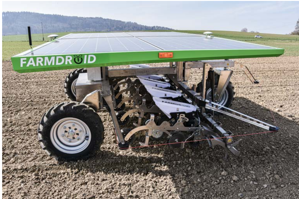
Der autonome Farmdroid-Roboter FD20 weiss, wo jede Rübenpflanze steht und hackt um sie herum. Urheberrechte: Hansueli Dierauer, FiBL
