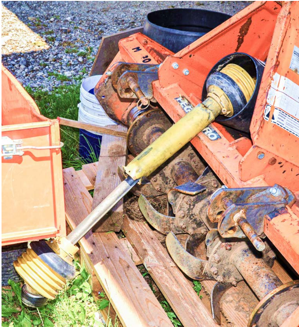
Gefahr beim unsachgemässen Einsatz von Maschinen: Während der arbeitsintensivsten Zeit werden Mängel wie dieser defekte Gelenkwellenschutz oft toleriert und die Behebung auf später verschoben. Urheberrechte: Mathias Reber, BUL
