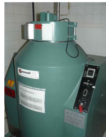
Figure 4. Irradiateur à rayons gamma ( ^{60}\text{Co} ). (IPCL, Seibersdorf)
