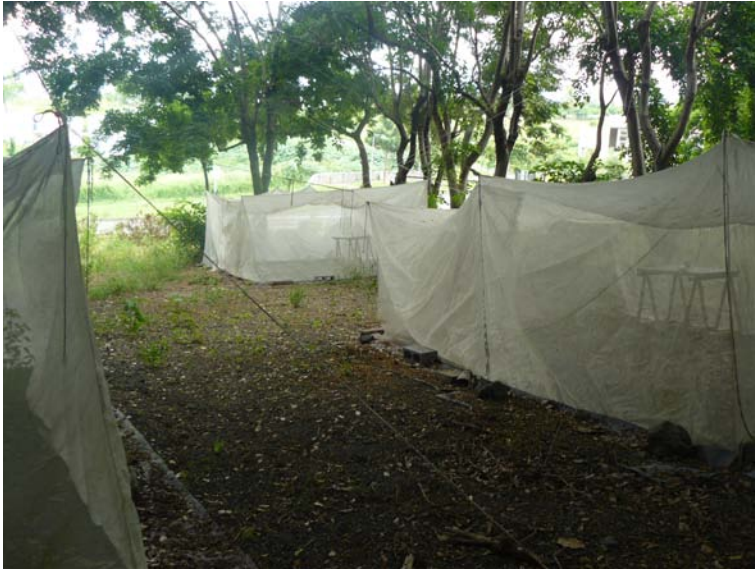
Figure 9. Enceintes en toile moustiquaire pour tests de compétitivité. (CIRAD La Bretagne, Ile de La Réunion)
