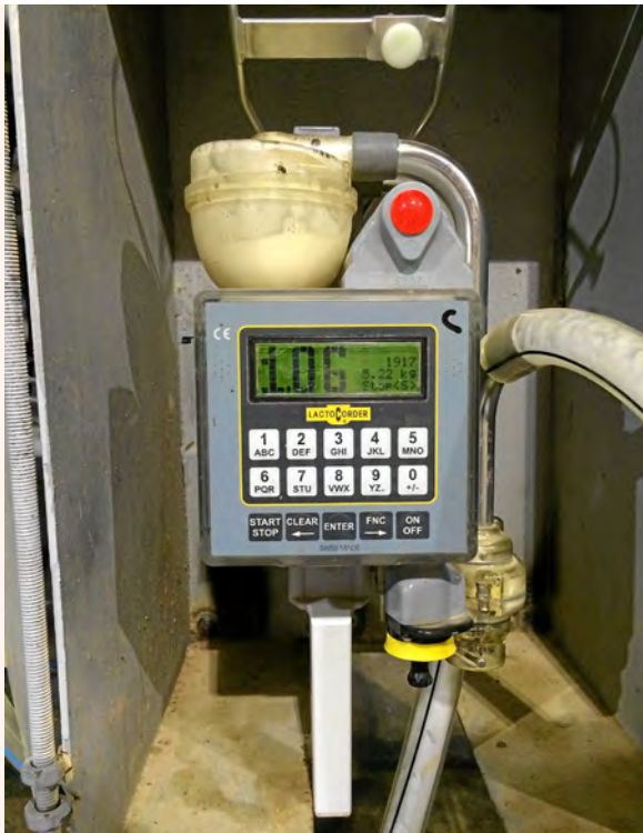
Figura 3.2. Dispositivo de registro automático del flujo de leche durante el ordeño. El instrumento es de tipo Lactocorder ©
