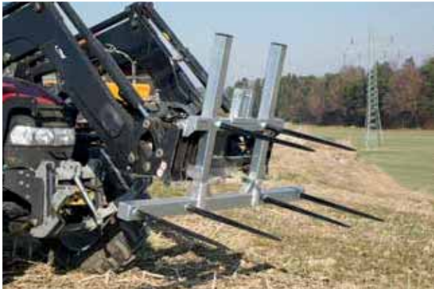
Abb. Ballengabel mit Erhöhung und sechs Rundballenzinken (2 Zinken - Aufpreis)
