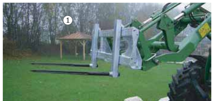
Verstellbare Aufnahme für Rundballenzinken (Schwerlastzinken; M28 x 1,5).
