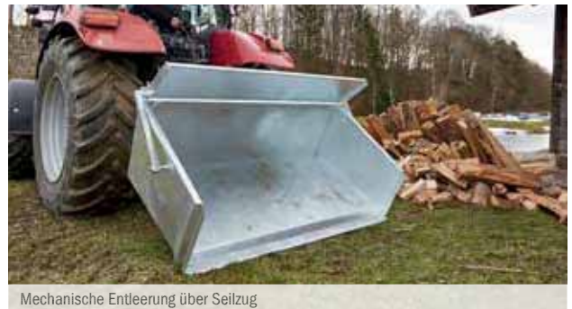
Mechanische Entleerung über Seilzug
