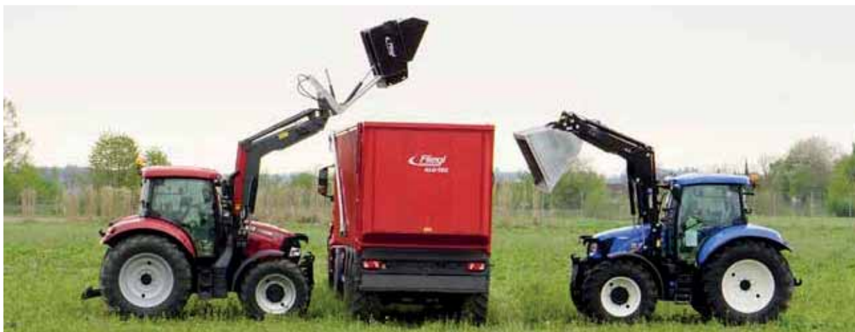
Darstellung der unterschiedlichen Kipphöhen bei gleichem Frontlader
