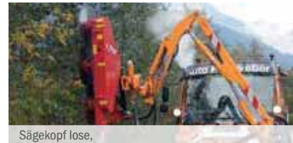
Sägekopf lose, auch für universellen Auslegearm erhältlich
