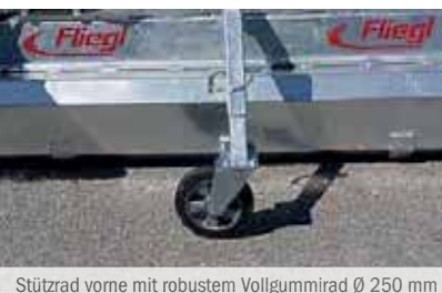
Stützrad vorne mit robustem Vollgummirad Ø 250 mm
