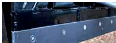
Geschraubte Schürfleiste, keine überstehende Schrauben
