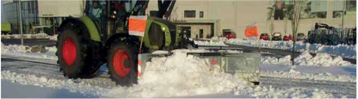
Die Räumbreite lässt sich durch die zwei Seitenflügel im vorgegebenen Bereich stufenlos einstellen. Optimal mit Warnflaggen.
