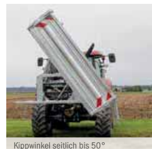
Kippwinkel seitlich bis 50°
