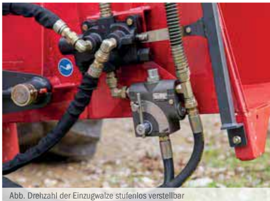
Abb. Drehzahl der Einzugswalze stufenlos verstellbar
