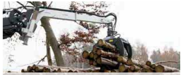
Hydraulische Rückezege LongNeck Combi Plus mit Endlosdrehmotor
