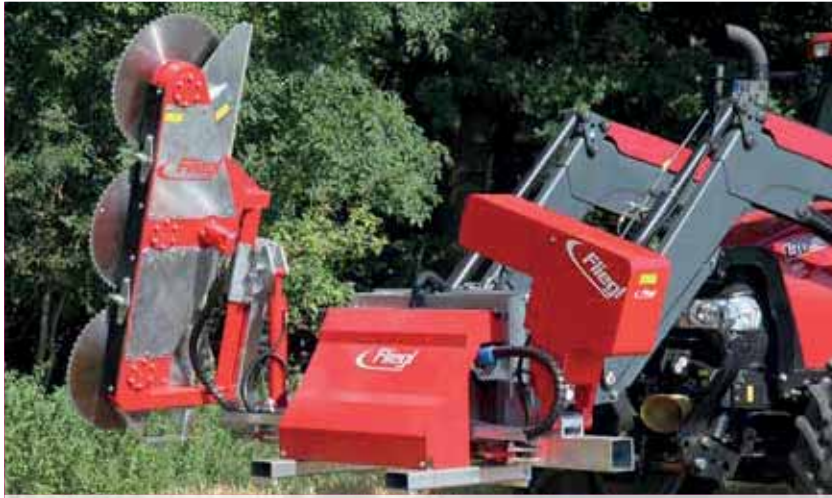
Flacher, speziell geformter Sägekopf für beste Sicht - ideal geeignet zum Schneiden von Sträuchern oder grobem Gestrüpp.
