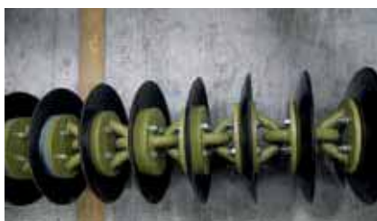
Verschleißfeste Stahlscheiben mit 130 mm Abstand
