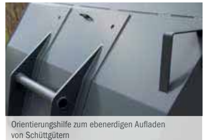
Versteifungsbleche sorgen für einen stabilen Unterbau
