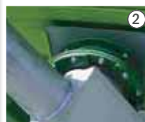
Über Drehgelenk einschiebbar am Fliegl-Kornschieber 400 x 300 mm
