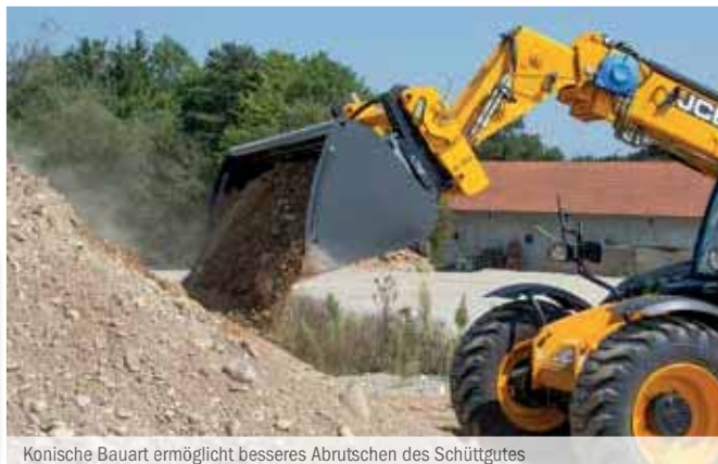
Konische Bauart ermöglicht besseres Abrutschen des Schüttgutes
