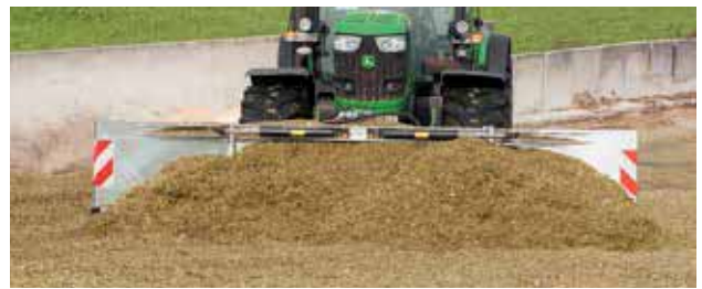
Die Räumbreite lässt sich durch die zwei Seitenflügel im vorgegebenen Bereich stufenlos einstellen. Optimal mit Warnflaggen.
