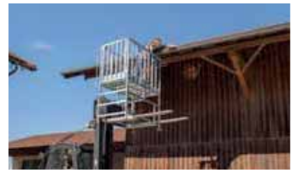
Abb. Anbau am Stapler mit Kettensicherung
