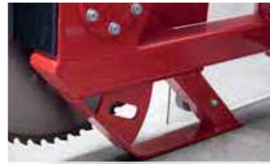
Ein Schutzbügel verhindert eine Berührung des untersten Sägeblattes mit dem Erreich.
