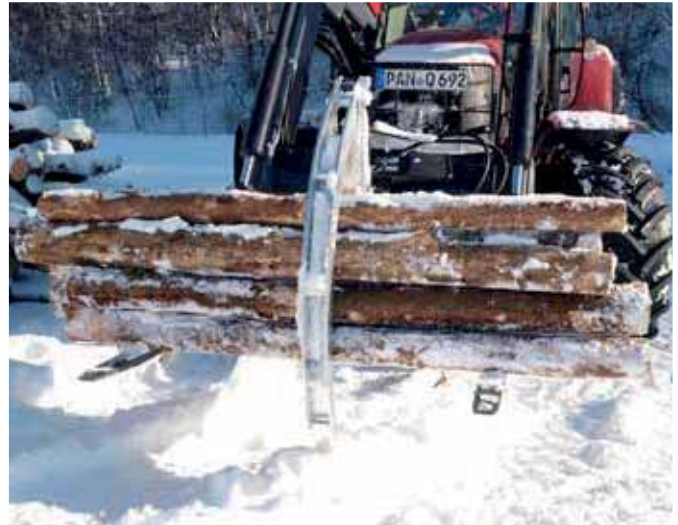
Hydraulischer Greifarm an der Staplergabel »Freisicht« befestigt
