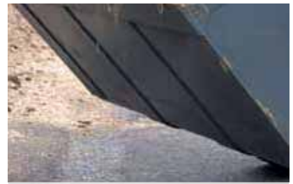
Versteifungsbleche sorgen für einen stabilen Unterbau
