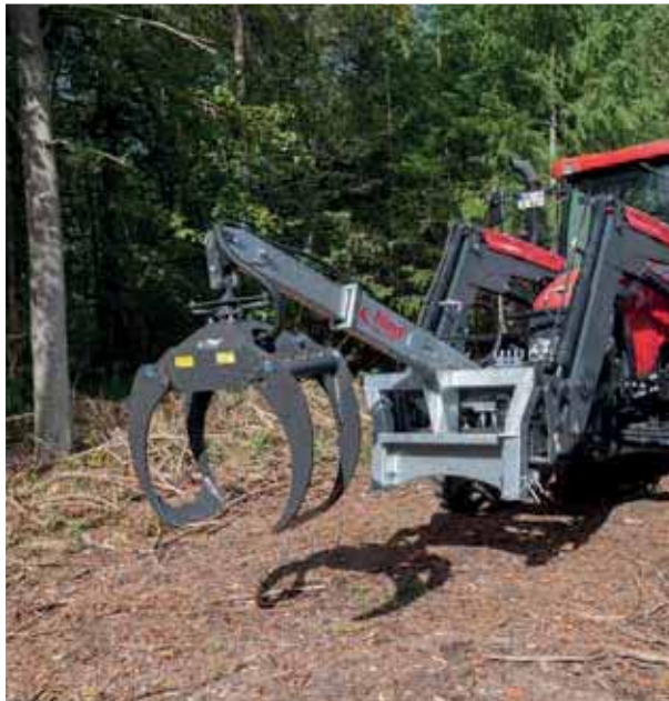
Hydraulische Rückezege LongNeck Combi mit mechanischem Drehgelenk
