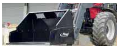
Aufbau mit Sichtausschnitt für maximales Volumen
