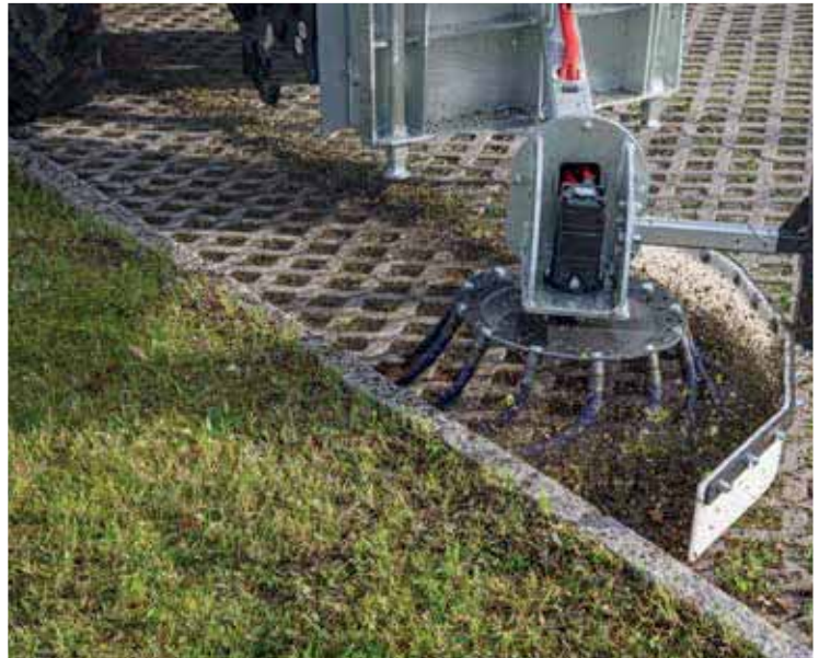
Beste Wildkrautentfernung durch ummantelte Stahlbürsten
