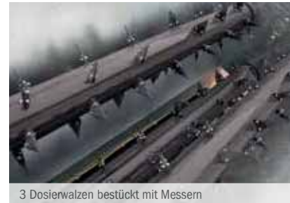
3 Dosierwalzen bestückt mit Messern
