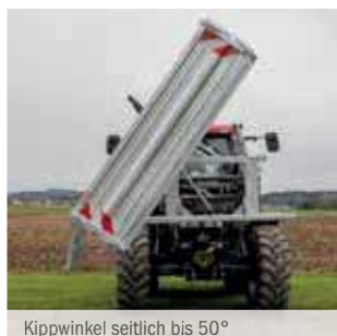
Kippwinkel seitlich bis 50°
