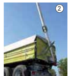
Ø 154 mm - Ausführung im eingeklappten Zustand
