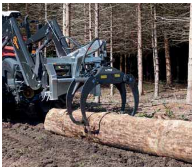
Hydr. Rückezege Combi RZ 185 mit mechanischem Drehgelenk
