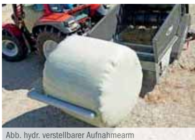
Abb. hydr. verstellbarer Aufnahmearm
