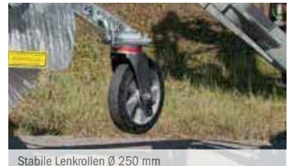
Stabile Lenkrollen Ø 250 mm
