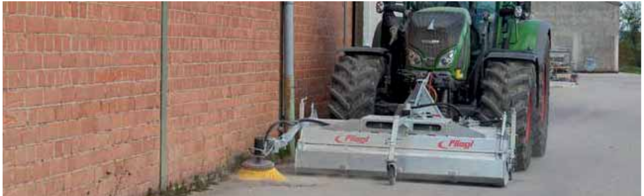
KEH Typ 500 mit Dreipunktaufnahme, hydraulische Schmutzsammelwanne, Seitenbesen und Frontstützrad
