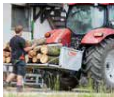
Ausklappbare Pendelwand dient als Muldenverlängerung
