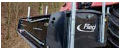
Rungen für Holztransport
