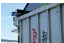
Hydraulisch angetriebener Ölmotor für das Einziehen des Abdecknetzes
