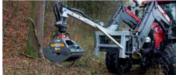
Abb. Verladezange mit Lasthakenverlängerung (Euro-Dreipunktaufnahme) und Drehmotor
