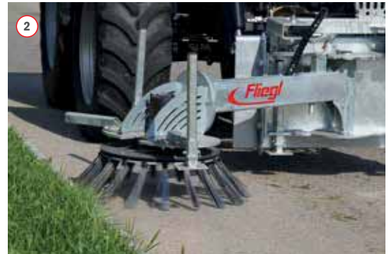
Beste Wildkrautentfernung durch ummantelte Stahlbürsten
