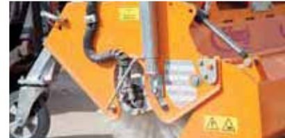
Stufenlose Kehrbesenverstellung durch Stützspindel
