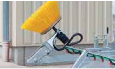
Mechanisch klappbarer Seitenbesen Ø 600 mm
