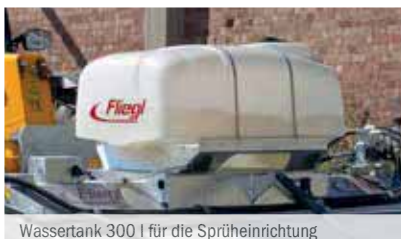
Wassertank 300 l für die Sprüheinrichtung
