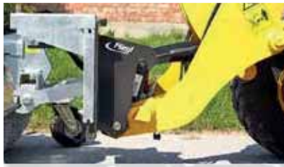
Radladeraufnahme mit Pendelausgleich
