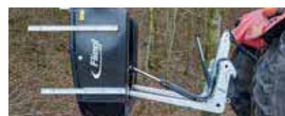
2-Zylinder-System für besten Kippwinkel 111°
