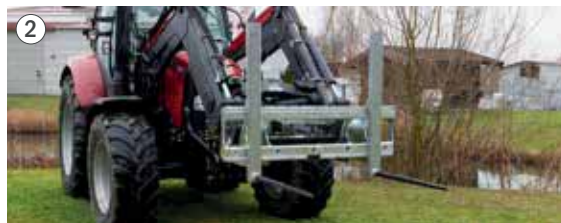
Verstellbare Aufnahme für Rundballenzinken (Schwerlastzinken; M28 x 1,5).
