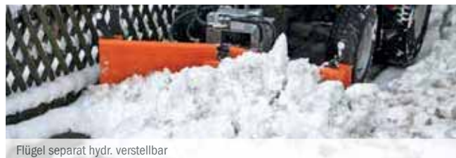
Flügel separat hydr. verstellbar
