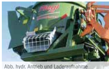
Abb. hydr. Antrieb und Laderaufnahme
