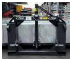
Aufnahmemöglichkeiten: Euronorm- und Dreipunkt- sowie Stapleraufnahme
