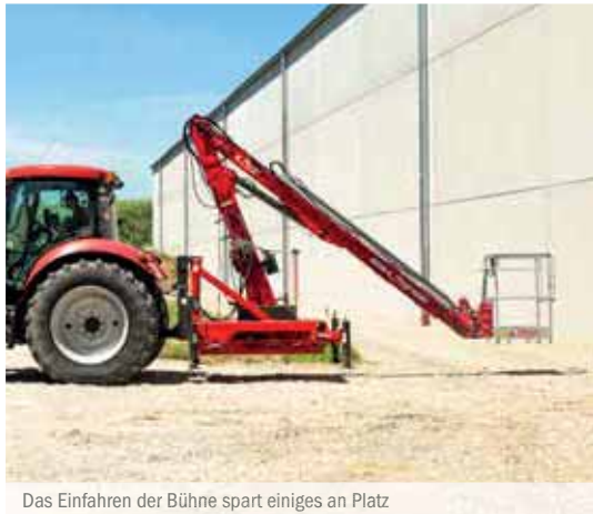
Das Einfahren der Bühne spart einiges an Platz
