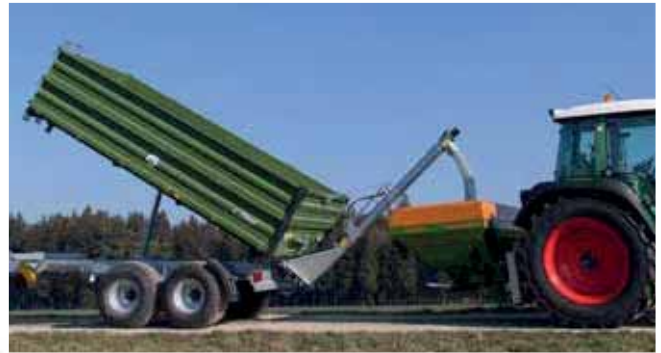
Die Überladeschnecke kann an jeden Kipper mit einfachster Montage angebracht werden. Die Bedienung ist mühelos. Stufenlose Verstellung des Austragewinkels mittels Seilwinde.
