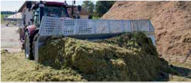
Aufbaugitter: Eine Erhöhung (400 mm) über die gesamte Arbeitsbreite des Planierschildes. Die Erhöhung wird einfach auf das Planierschild aufgeschraubt.
