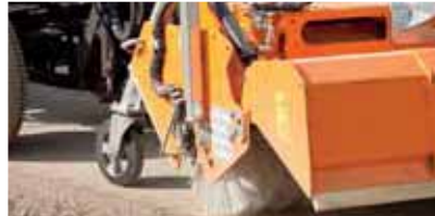
Serienmäßig mit Freikehrmodus: Kehren mit geöffneter Schmutzsammelwanne
