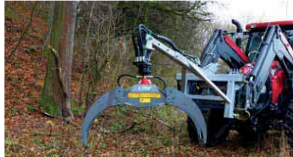
Abb. Verladezange mit Lasthakenverlängerung (Euro-Dreipunktaufnahme) und Drehmotor
