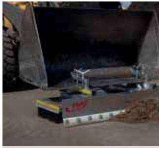
Kehrbesen Löwe mit Planierschild – räumt selbst festgefahrene Verschmutzungen
