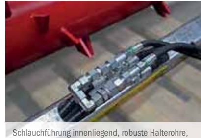
Schlauchführung innenliegend, robuste Halterohre, dadurch bester Schutz für Schläuche
