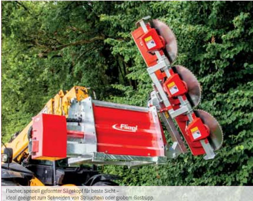
Flacher, speziell geformter Sägekopf für beste Sicht - ideal geeignet zum Schneiden von Sträuchern oder grobem Gestrüpp.
