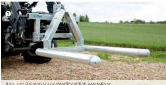
Abb. mit Ballentransportgerät seitlich verstellbar
