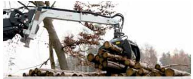
Hydraulische Rückezege LongNeck Combi Plus mit Endlosdrehmotor
