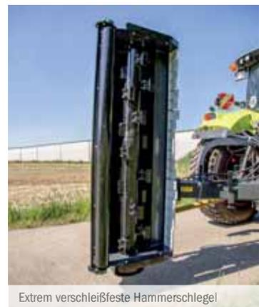
Extrem verschleißfeste Hammerschlegel
