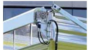
Hydraulisch angetriebener Ölmotor für das Einziehen des Abdecknetzes
