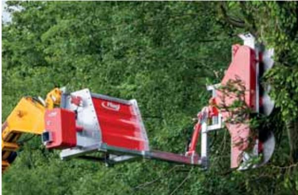
Abb.: Verwendung bei Teleskoplader mit Linksanbau
