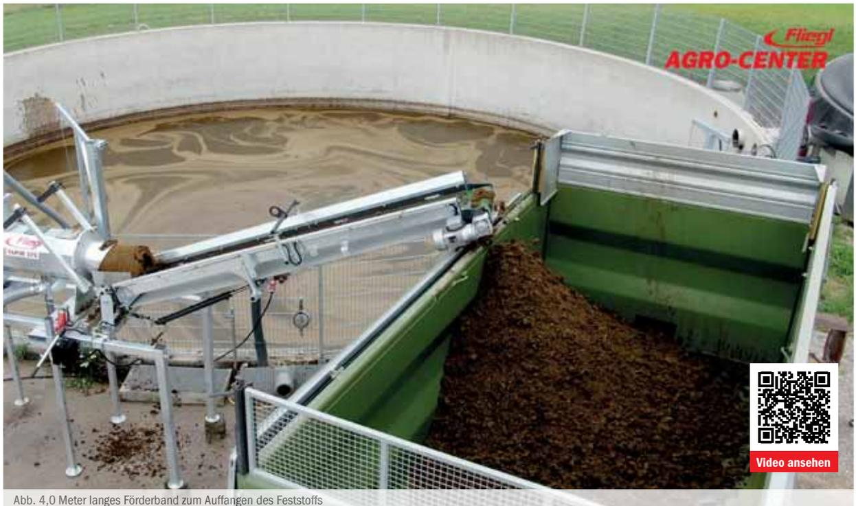
Abb. 4,0 Meter langes Förderband zum Auffangen des Feststoffs
