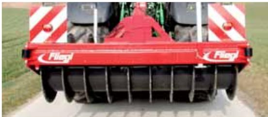
Abb. mit Warntafel-Set, optional für Geräte mit Überbreite
