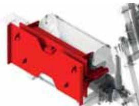
Überlastsicherung: Bei zu hohem Anpressdruck neigt sich der Kopf nach hinten zum Schutz vor Blockieren.
