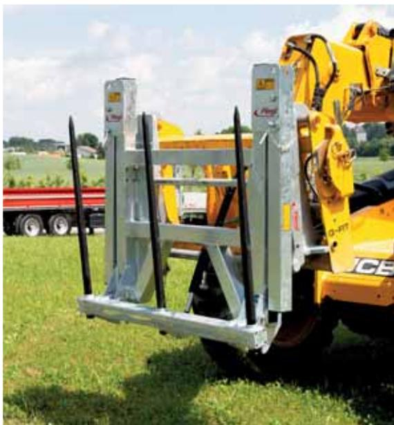
Abb. eingeklappte Ballengabel besonders kompakt
