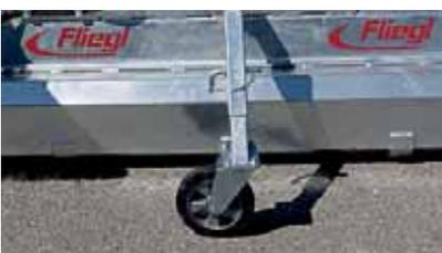
Stützrad vorne mit robustem Vollgummireifen Ø 250 mm
