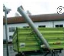
Ø 154 mm - Ausführung im eingeklappten Zustand
