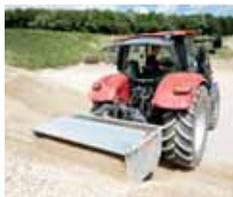
Abb. Pendelwand nach oben geklappt
