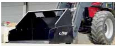
Aufbau mit Sichtausschnitt für maximales Volumen
