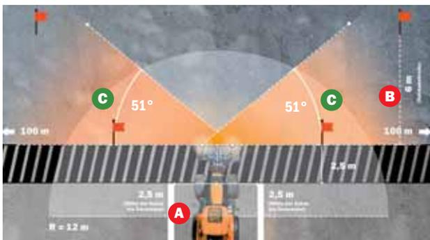
Ein Praxisbeispiel, die das Querverkehr-Kamerasystem als Lebensretter zeigt: **A** steht hierbei für das aktive Blickfeld des Fahrers, **B** für die Gefahrenzone, die der Fahrer nicht einsehen kann und **C** für das Sichtfeld des Kamerasystems – Passanten, Rad- und Autofahrer werden sofort erkannt.
