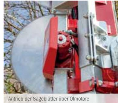
Antrieb der Sägeblätter über Ölmotore
