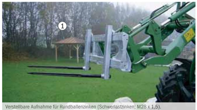
Verstellbare Aufnahme für Rundballenzinken (Schwerlastzinken; M28 x 1,5).
