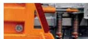
Überlastsicherung durch Federklappen gewährleisten beschädigungsfreies Fahren
