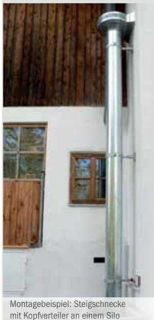
Montagebeispiel: Steigschnecke mit Kopfverteiler an einem Silo
