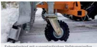
Schwerlastrad mit superelastischen Vollgummireifen (Ø 306 mm), Breite: 105 mm, kugelgelagert, abriebfeste Lauffläche, stahlgeschweißte Schwerlastrolle, schwere Drehkranzausführung, Spindel verstellbar
