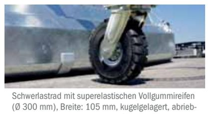
Schwerlastrad mit superelastischen Vollgummireifen (Ø 300 mm), Breite: 105 mm, kugelgelagert, abriebfeste Lauffläche, stahlgeschweißte Schwerlastrolle, schwere Drehkranzausführung, Spindel verstellbar
