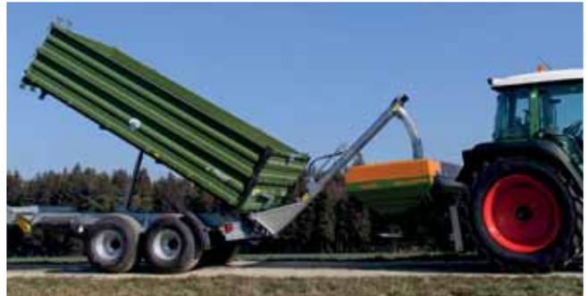
Die Überladeschnecke kann an jeden Kipper mit einfachster Montage angebracht werden. Die Bedienung ist mühelos. Stufenlose Verstellung des Austragewinkels mittels Seilwinde.
