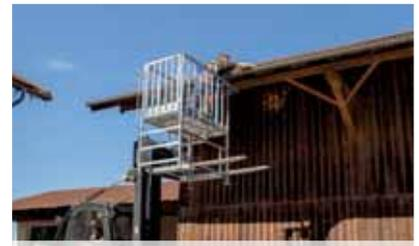
Abb. Anbau am Stapler mit Kettensicherung
