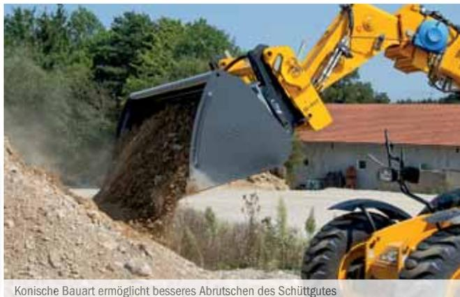
Konische Bauart ermöglicht besseres Abrutschen des Schüttgutes
