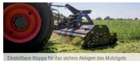
Einstellbare Klappe für das sichere Ablegen des Mulchguts
