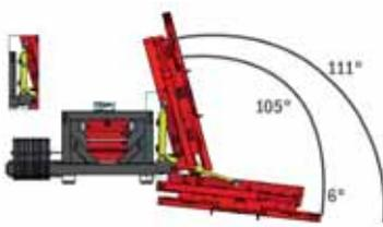
Neigevorrichtung 111° - zum Senkrecht- und Waagrechtsschneiden. Der Winkel kann dabei stufenlos eingestellt werden.
