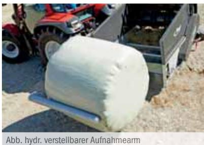
Abb. hydr. verstellbarer Aufnahmearm
