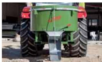
Abb. Auslaufrutsche schwenkbar
