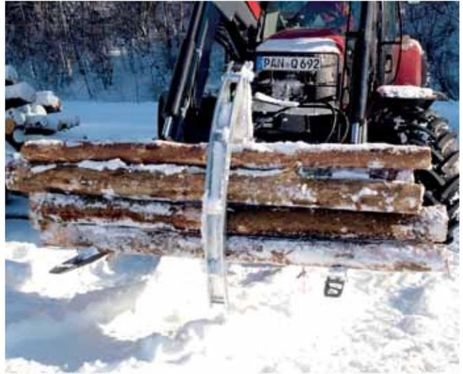
Hydraulischer Greifarm an der Staplergabel »Freisicht« befestigt
