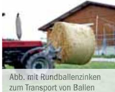
Abb. mit Rundballenzinken zum Transport von Ballen
