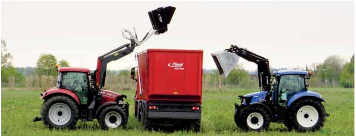
Darstellung der unterschiedlichen Kipphöhen bei gleichem Frontlader
