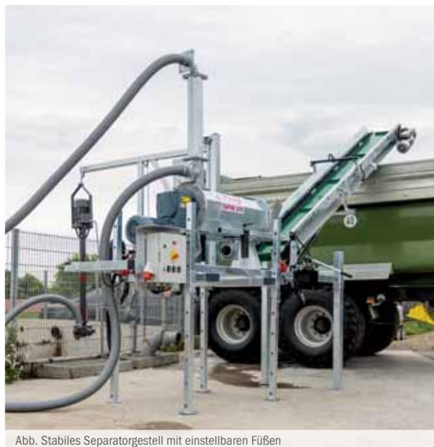
Abb. Stabiles Separatorgestell mit einstellbaren Füßen
