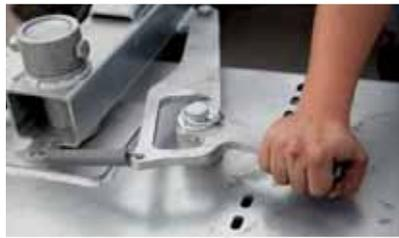
Schwenkbock mechanisch (30° nach links und rechts)
