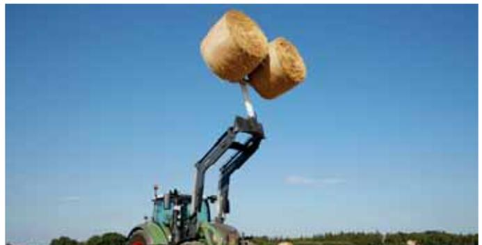
Abb. Hubstapler und Ballengabel mit hydr. Niederhalter (optional)
