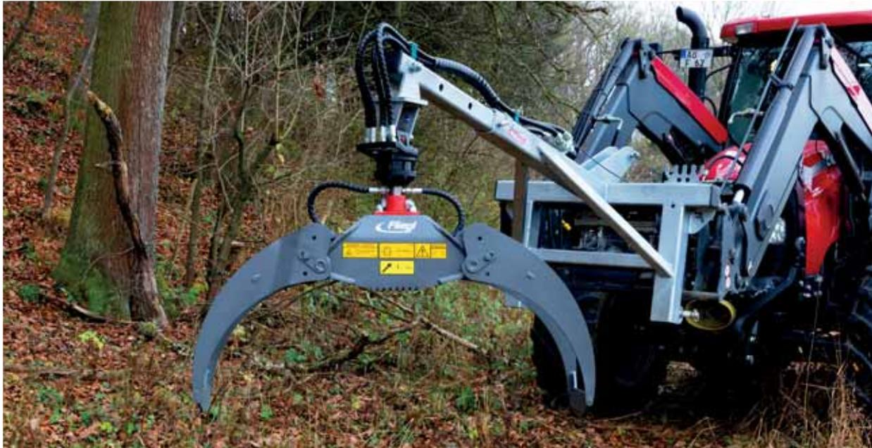
Verladezange mit Lasthakenverlängerung (Euro-Dreipunktaufnahme) & Drehmotor
