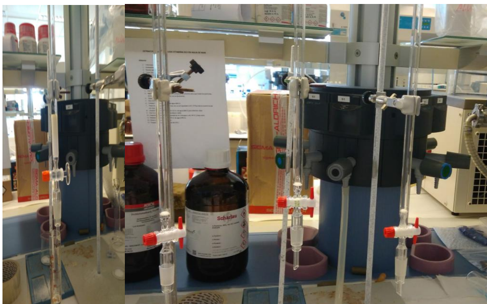
Figura 5: Purificación mediante extracción en fase sólida (clean-up).
