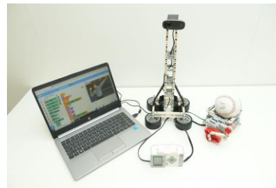
圖 2 學生表現：以人工智能應用製作壘球監察器 圖 3 學生表現：壘球監察器成品
