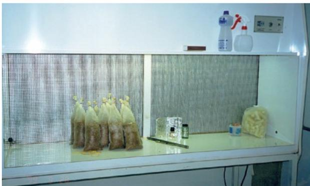
**Figura 2.** Câmara de fluxo laminar.
