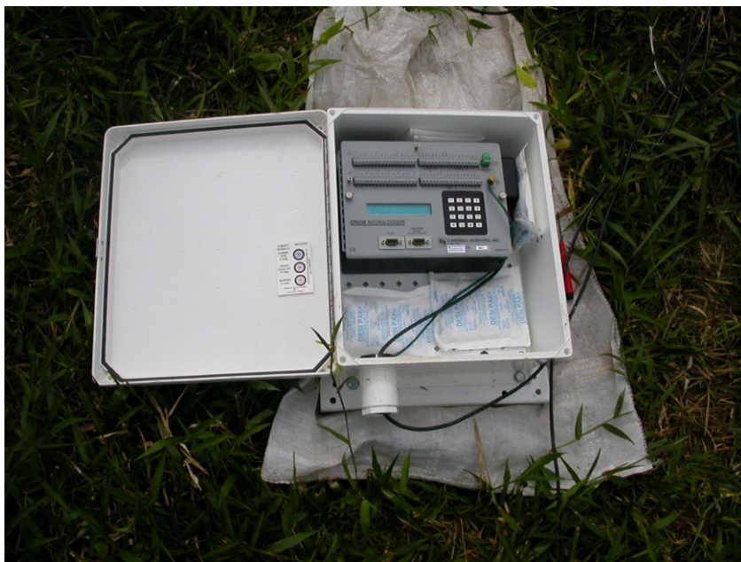
Fig. 1. Datalogger Campbell CR 23 X utilizado para armazenar as estimativas da umidade volumétrica do solo por sondas TDR.
