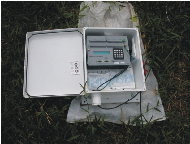
Figura 1. Aspecto do Datalogger Campbell CR 23 X utilizado para armazenar as estimativas da umidade volumétrica do solo por sondas TDR.
