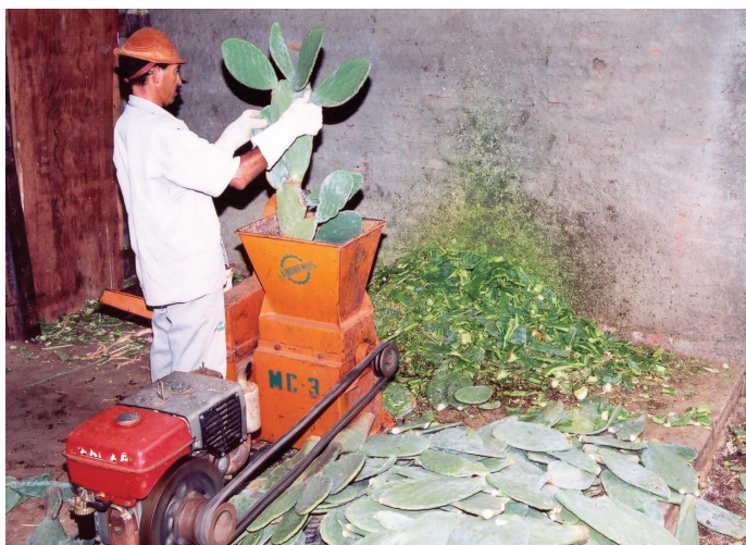
Fig. 2. Operação de trituração da palma utilizando-se máquina combinada.
