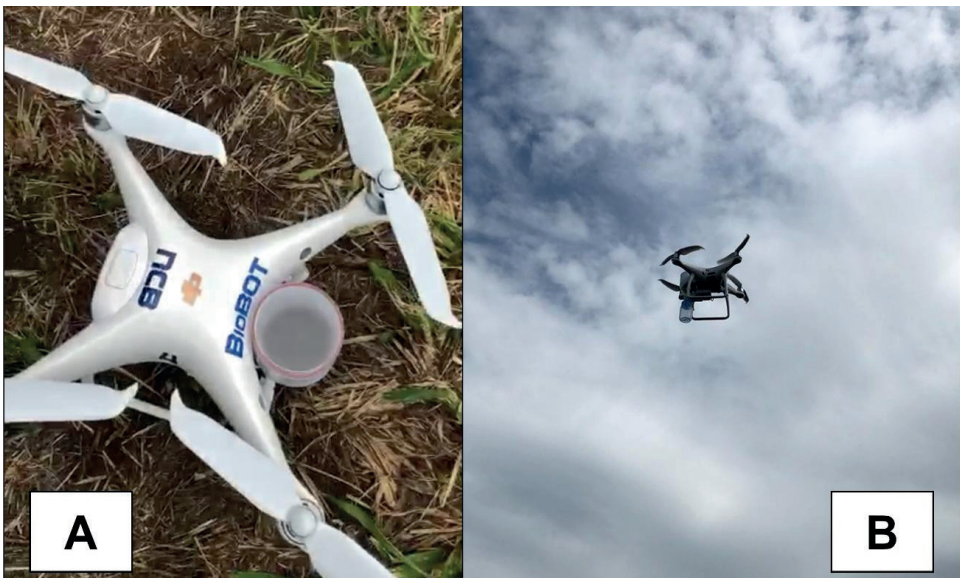
Figura 9. Método de liberação de macroorganismos a granel em campo via drone. (A) detalhe do drone com dispenser acoplado; (B) liberação a granel sob comando de dispositivo digital automatizado.
