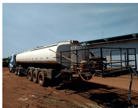
Figura 6. Sistema de preparo de caldas com pré-misturador em inox e com sistema de agitação.
