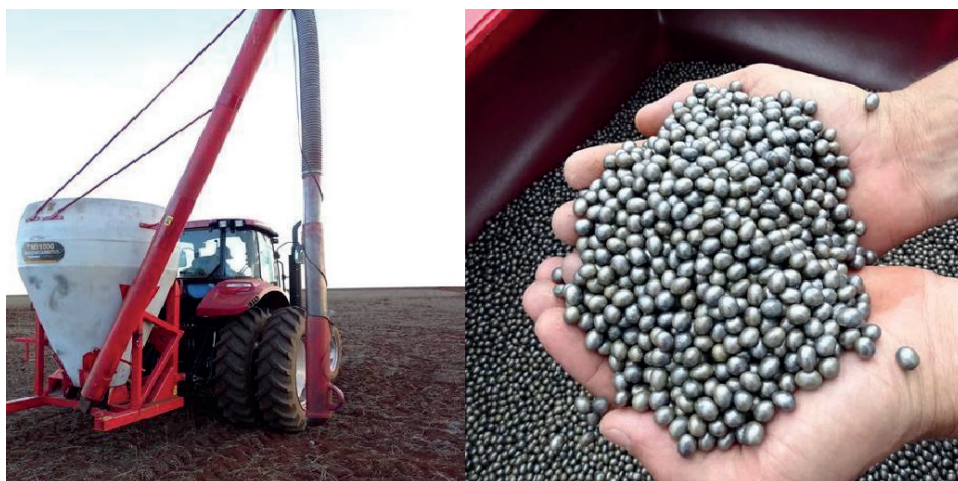
Figura 13. Máquina para tratar grandes volumes de sementes, acoplável ao sistema de engate de três pontos dos tratores e detalhe do serviço realizado.
