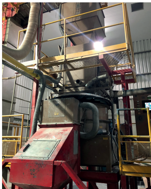
Figura 5. Equipamento de tratamento industrial via pulverização das sementes.
