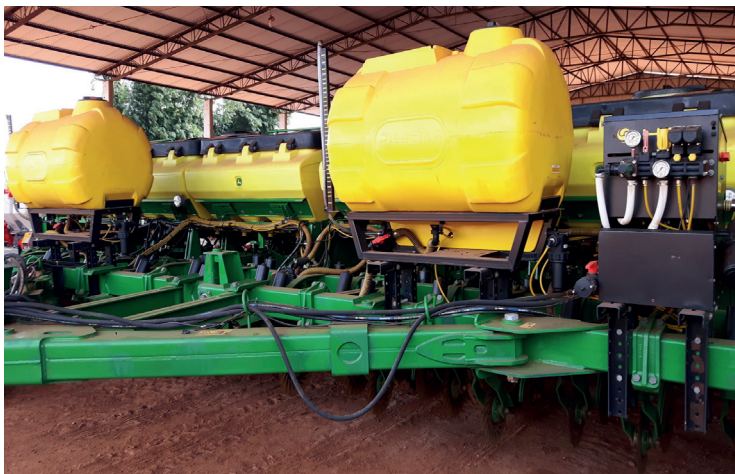
Figura 8. Semeadora equipada com sistema de tratamento em sulco de cultivo.
