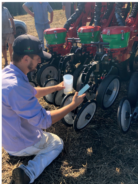
Figura 9. Calibragem do sistema de distribuição da calda no sulco de cultivo.
