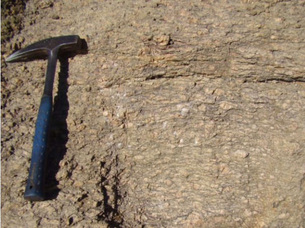
Fig 1: Rochas metamórficas do complexo Cambaí, gnaisses com bandeamento subverticalizado, regular e descontínuo, alternando bandas (mm) máficas e félsicas com presença de K-feldspato.
