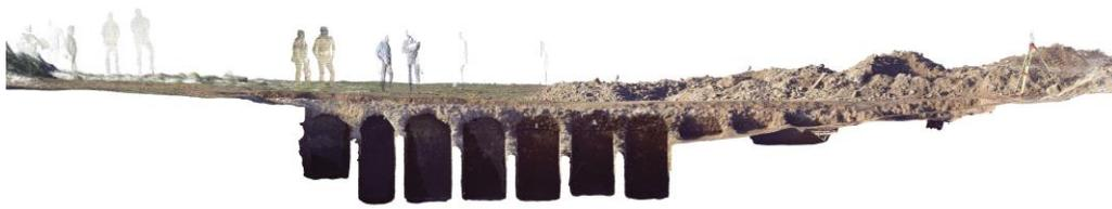
Fig. 4. Sezione delle celle dell'ambiente V elaborata con laser scanner (rilievo con laser scanner a cura di Marco Concari).
