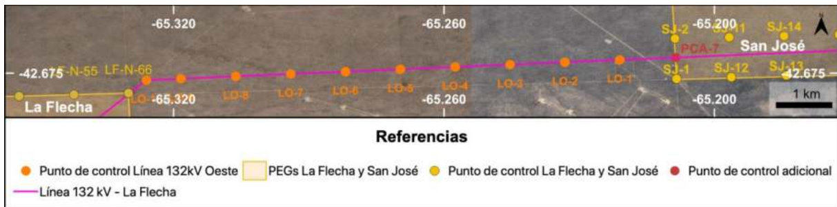
Figura 5. Distribución de puntos de control sistemáticos (LO) y puntos de control adicionales (PCA) en la línea eléctrica de 132 kV, entre las áreas “La Flecha Norte” y “San José”.
