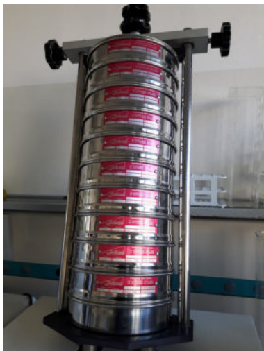
Foto 3 Vibrosetacciatore e relativi setacci utilizzati
