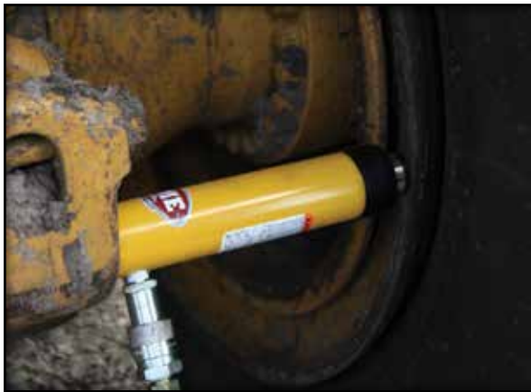
Arietes hidráulicos son utilizados para romper soltar talones traseros
