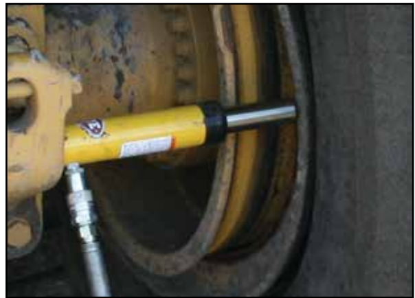
Arietes hidráulicos son utilizados para romper soltar talones traseros
