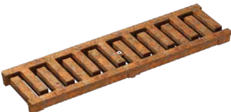
Stegrost, MASSIV 32, Gusseisen unbeschichtet, Gusseisen KTL beschichtet Belastungsklasse: E600* , Länge: 50 cm, SW 11 mm Nur für KE-100 geeignet.
