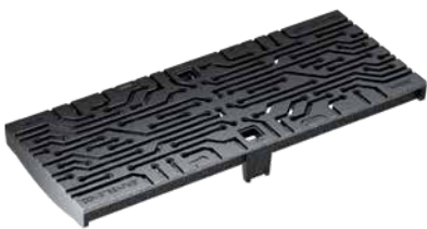
Gussrost, WIRE Design, Guss GJS, KTL beschichtet Belastungsklasse: D400* Länge: 50 cm, SW 5 mm
