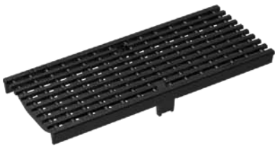
Längsstabrost, Guss GJS, KTL beschichtet Belastungsklassen: D400*, E600* Länge: 50 cm, MW 25 x 11 mm
