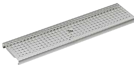
Lochrost, Stahl verzinkt, Edelstahl Belastungsklassen: A15, C250 , Länge: 50 cm, 100 cm, Ø 6 mm
