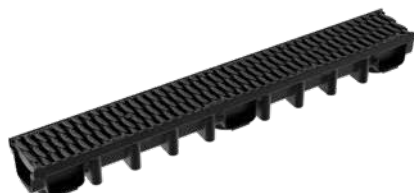
EVO 0100 Rinne u. Einlaufkasten mit Polyamid-Kunststoffrost Kl.B125
