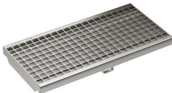
Maschenrost, Stahl verzinkt, Edelstahl Belastungsklassen: D400* Länge: 50 cm, 100 cm, MW 20 x 20 mm
