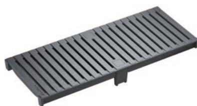
Stegrost, HEELGUARD, Guss GJS, schwarz lackiert Belastungsklasse: D400* Länge: 50 cm, SW 6 mm
