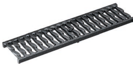
Stegrost, OvalGrip Design, Gusseisen, KTL beschichtet Belastungsklassen: C250, E600* , Länge: 50 cm, SW 10 mm
