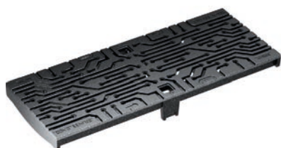
Gussrost, WIRE Design, Guss GJS, KTL beschichtet Belastungsklasse: D400* Länge: 50 cm, SW 5 mm
