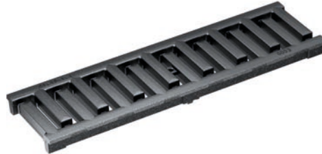
Stegrost, MASSIV 32, Gusseisen GJS, KTL- beschichtet Belastungsklasse: E600* , Länge: 50 cm, SW 11 mm Nur für KE-100 geeignet.
