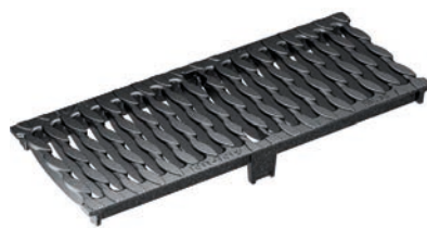
Guss-Stegrost mit OvalGrip Design, Guss GJS, KTL beschichtet Belastungsklassen: D400*, E600* Länge: 50 cm, SW 12 mm
