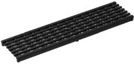
Längsstabrost, Gusseisen, KTL beschichtet Belastungsklasse: D400* , Länge: 50 cm, MW 25 x 10 mm
