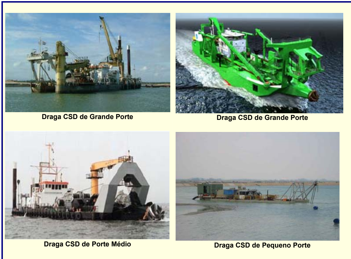
Figura 3.9.1 – Exemplos das Tipologias e Portes das Dragas previstas
