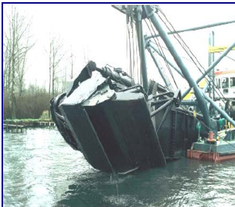
Figura 3.4.6: Detalhe da Draga CSD equipada com sweep dredge na cabeça de dragagem
