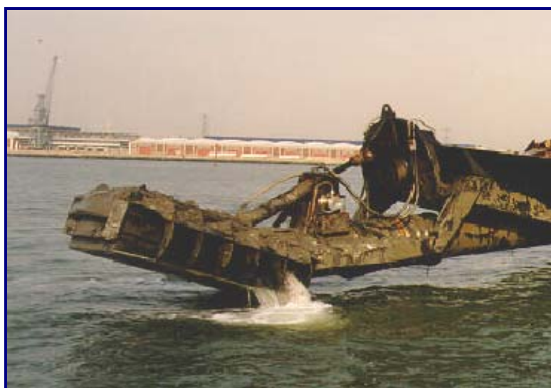
Figura 3.4.7: Detalhe da Draga CSD equipada com auger dredge na cabeça de dragagem
