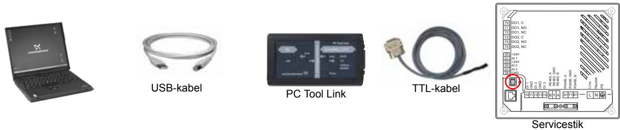
Fig. 29 Tilslutning af pc til CR Monitor ved hjælp af PC Tool Link
