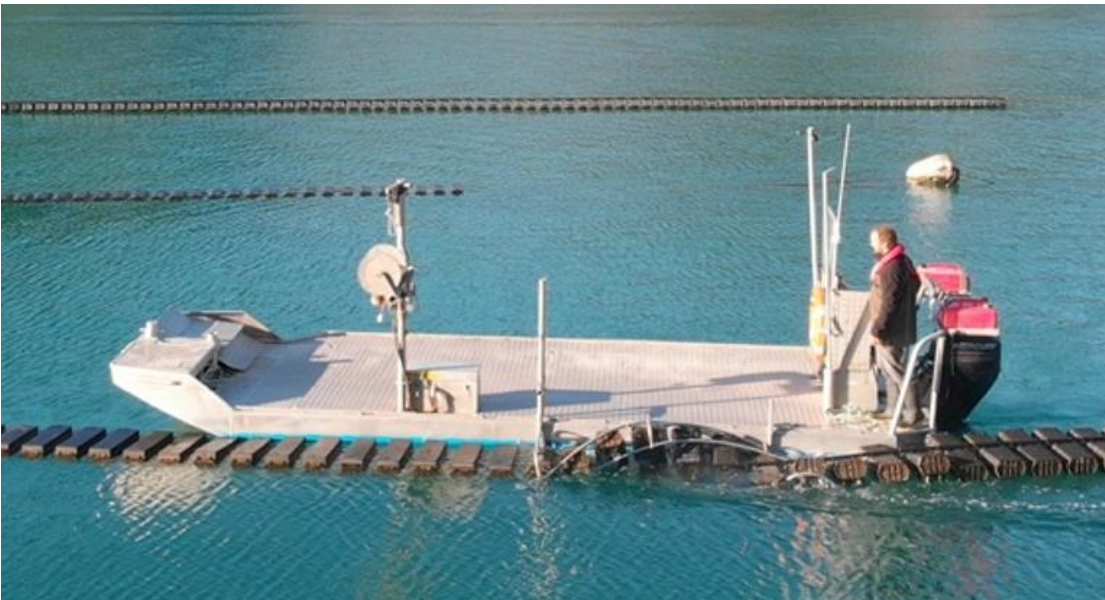
Figura II-30. Volteo de canastas con el sistema semi-mecanizado
