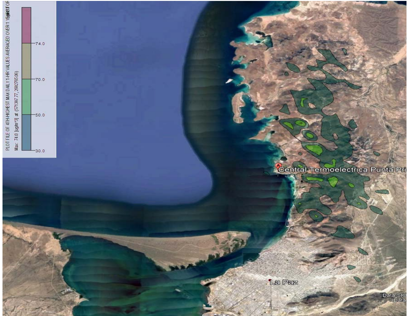
Figura IV.1.1-2.2 Curvas de isoconcentración del NO 2 por la operación de dos unidades de generación de vapor utilizando gas natural.
