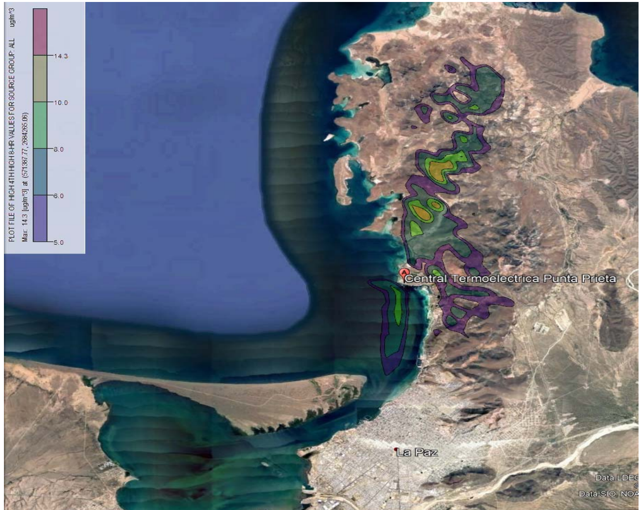
Figura V.3. . Curvas de isoconcentración de CO para la operación de dos unidades móviles utilizando gas natural
