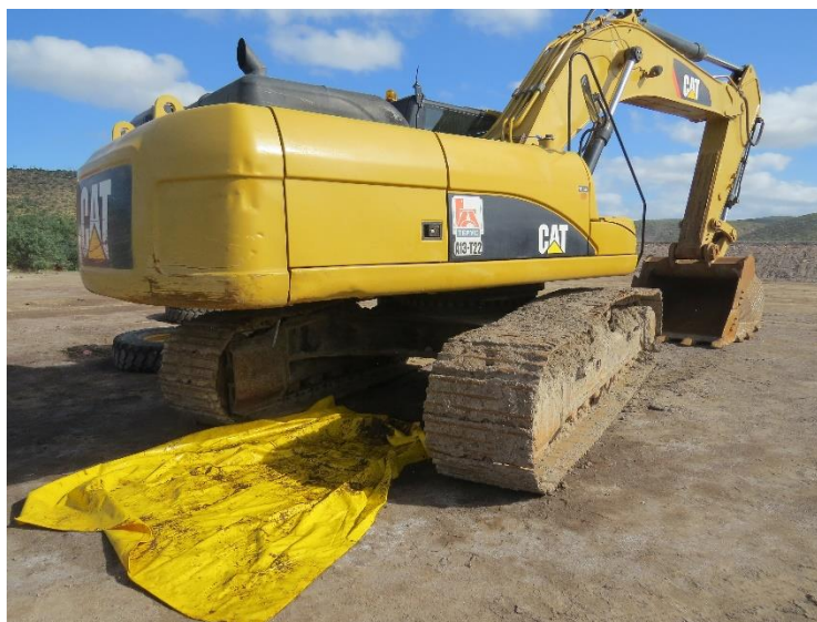
Figura 5. Colocación de material debajo de maquinaria para realizar reparaciones o inspecciones urgentes de maquinaria.
