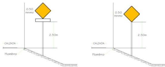
DISTANCIA LATERAL Y ALTURA DE LAS SEÑALES PREVENTIVAS EN TERRAPLEN
