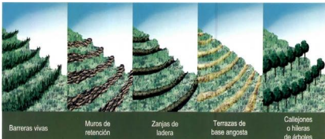
Figura VII. 9 Ejemplos de barreras de retención de suelo
