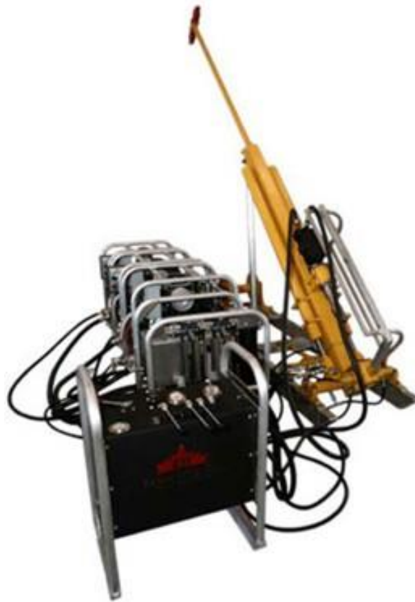
Fotografía 1. Perforadora tipo EGD III
