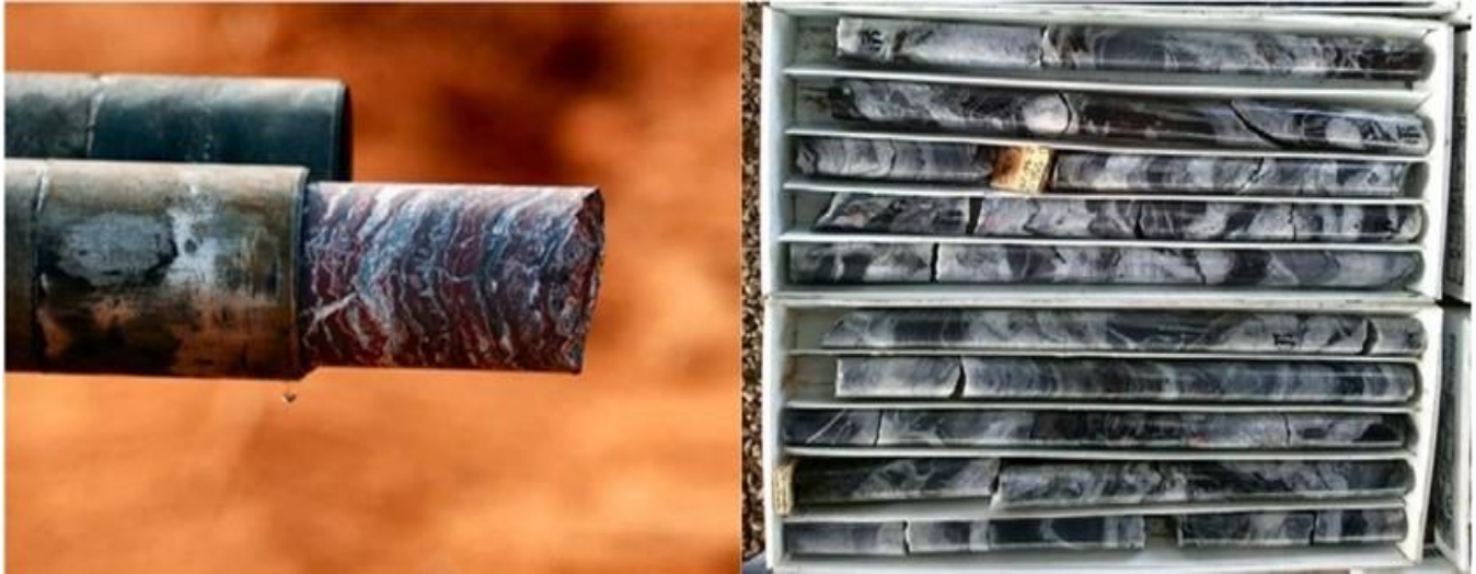
Fotografía 2. Testigo de roca (núcleo) saliendo de la tubería de barrenación, núcleo acomodado en cajas para ser analizado.
