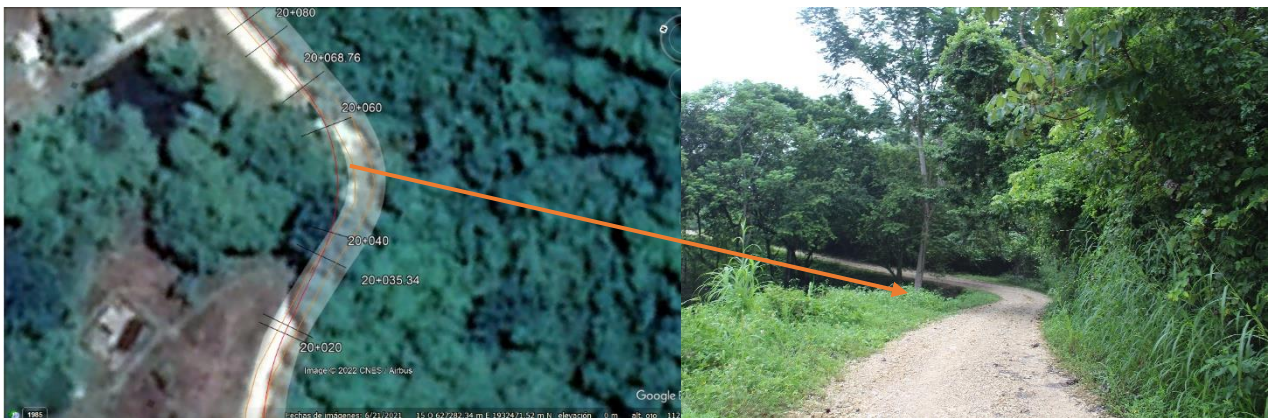
Figura 11. Tramo de alineación 2. Se alineará la curva hacia la izquierda, por lo que se afecta VSaSAP.
