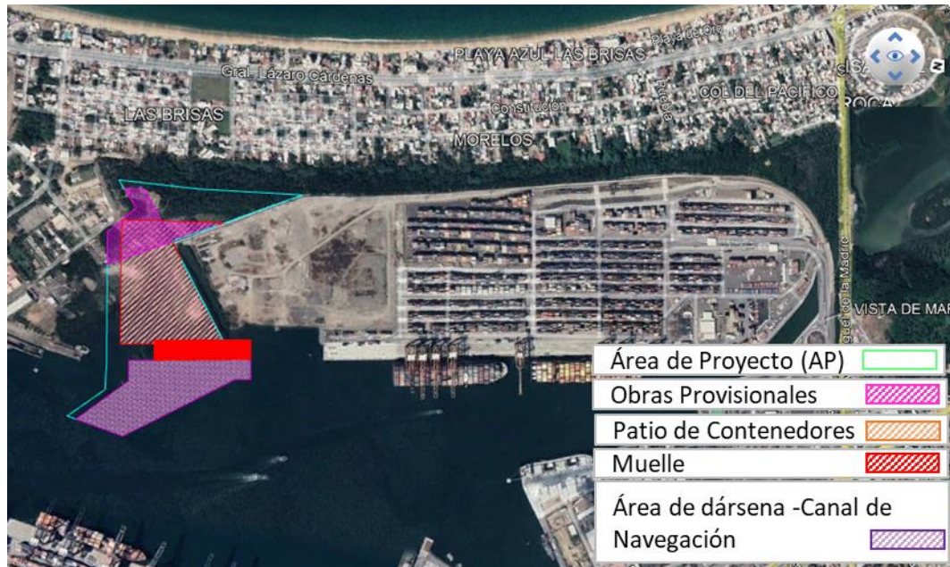
Figura II. 9 Área de ocupación directa del Proyecto. Área de patio de contenedores (naranja), área de muelle (rojo) área de obras provisionales (magenta) y área de dársena de atraque y aproximación del canal de navegación (morado).
