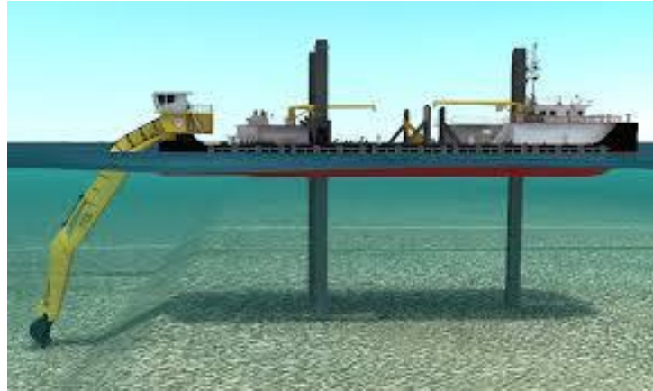
Figura II. 25 Ejemplo de dragado y limpieza de suelo marino. FUENTE: CONTECON MANZANILLO, S.A. DE C.V.
