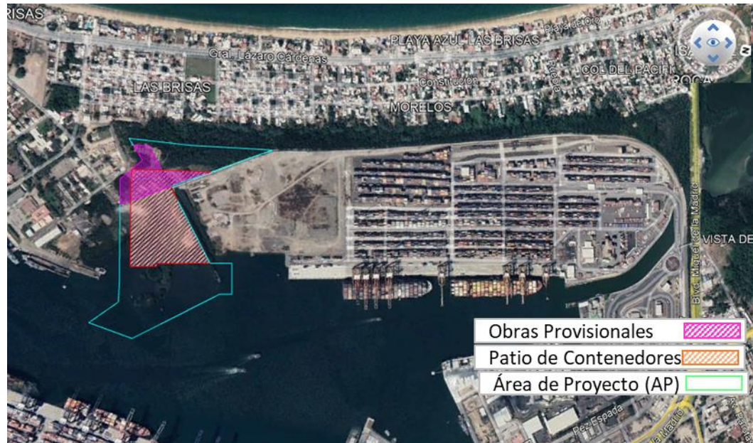
Figura II. 12. Área de obras provisionales.
