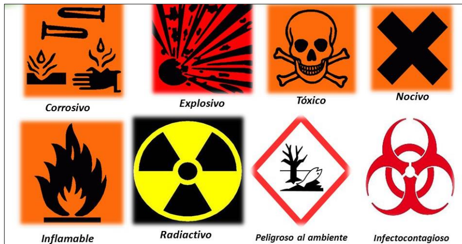
Figura VI-7. Símbolos indicadores de residuos peligrosos.
