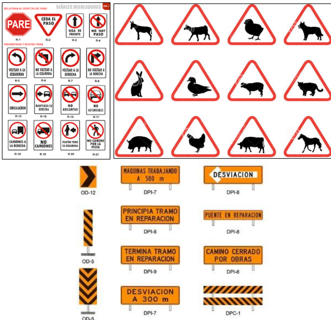
Figura VI-2. Señales informativas de obras
