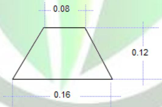
Ilustración 14. Estructura de los bordillos
