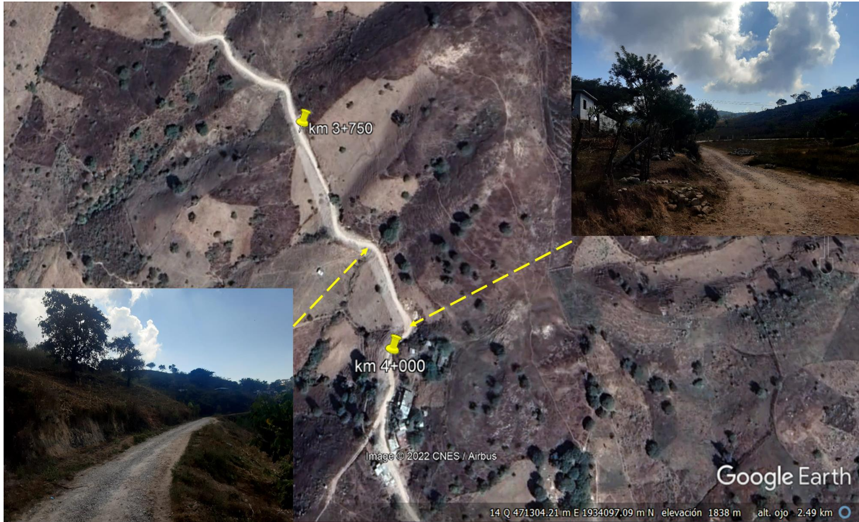
Ilustración 83.- Imagen satelital del tramo km 3+750 al km 4+000, donde el uso de suelo es agricultura de temporal anual con un ancho camino de 5.8 a 6.5 metros con especies de bosque de encino y selva baja caducifolia en los costados del camino.
