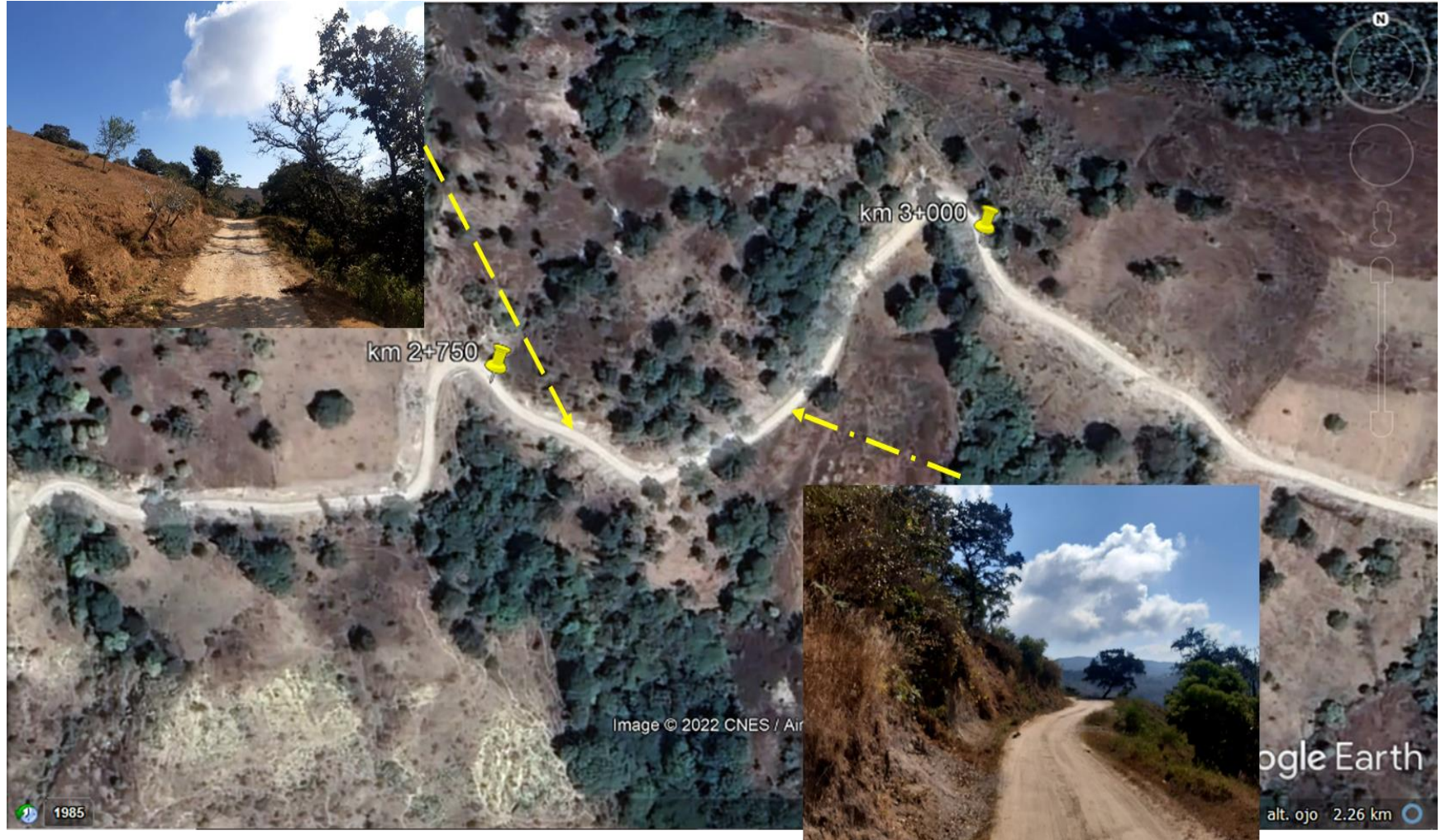
Ilustración 81.- Imagen satelital del tramo km 2+750 al km 3+000, donde el uso de suelo es agricultura de temporal anual con un ancho camino de 5.5 a 6.7 metros con especies de vegetación secundaria de bosque de encino en los costados del camino.
