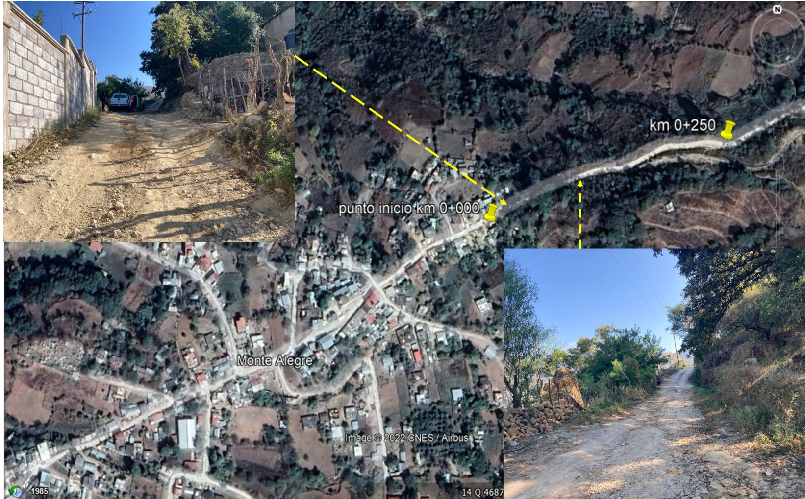
Ilustración 75.- Imagen satelital del tramo km 0+000 al km 0+250, inicia en el poblado de Monte Alegre, donde el uso de suelo es zona urbana y agricultura de temporal anual con un ancho de camino de 4.8 metros con árboles aislados de vegetación secundaria de bosque de encino y selva baja caducifolia en los costados del camino.
