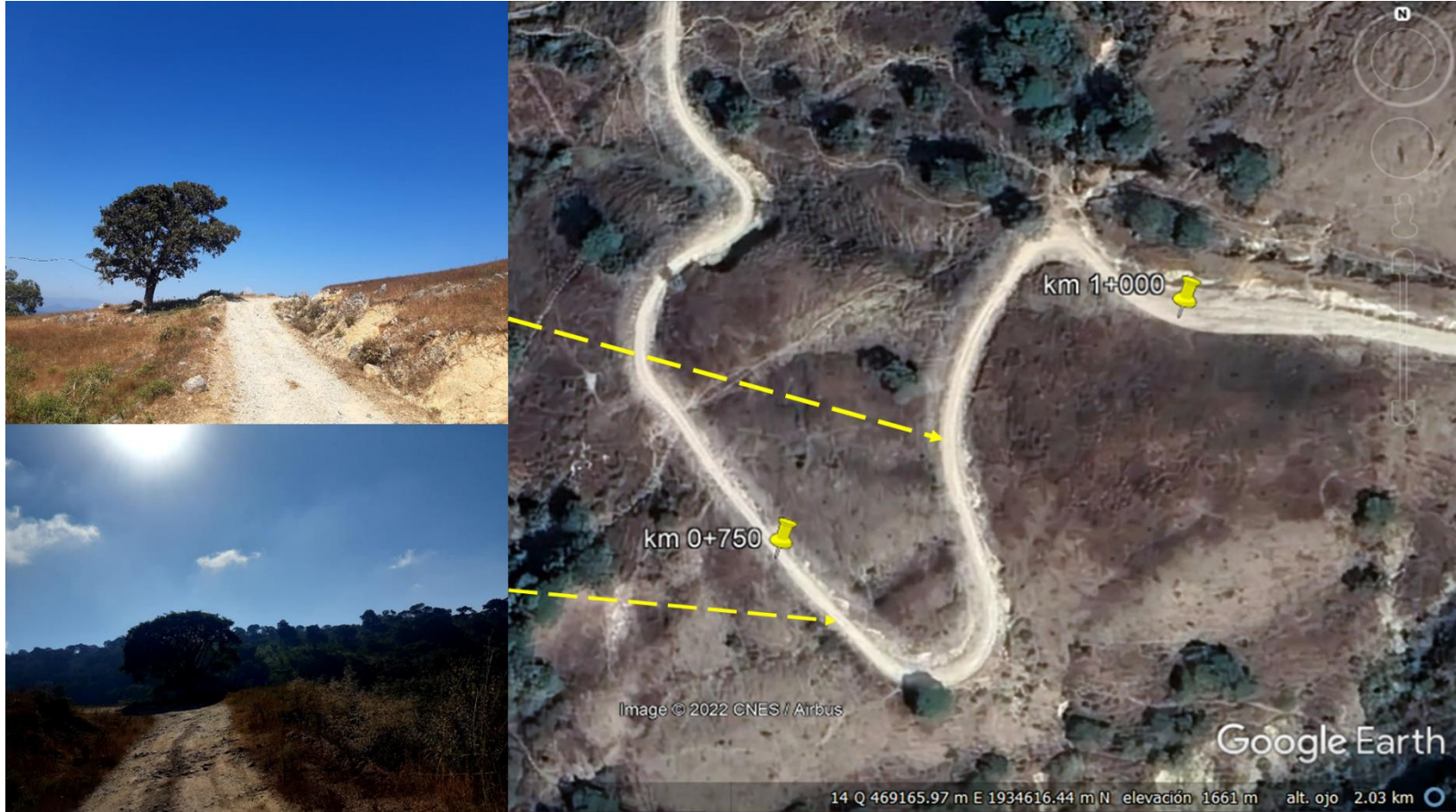
Ilustración 77.- Imagen satelital del tramo km 0+750 al km 1+000, donde el uso de suelo es agricultura de temporal anual con un ancho camino de 5.2 a 6.7 metros con especies aisladas de bosque de encino y selva baja caducifolia en los costados del camino.
