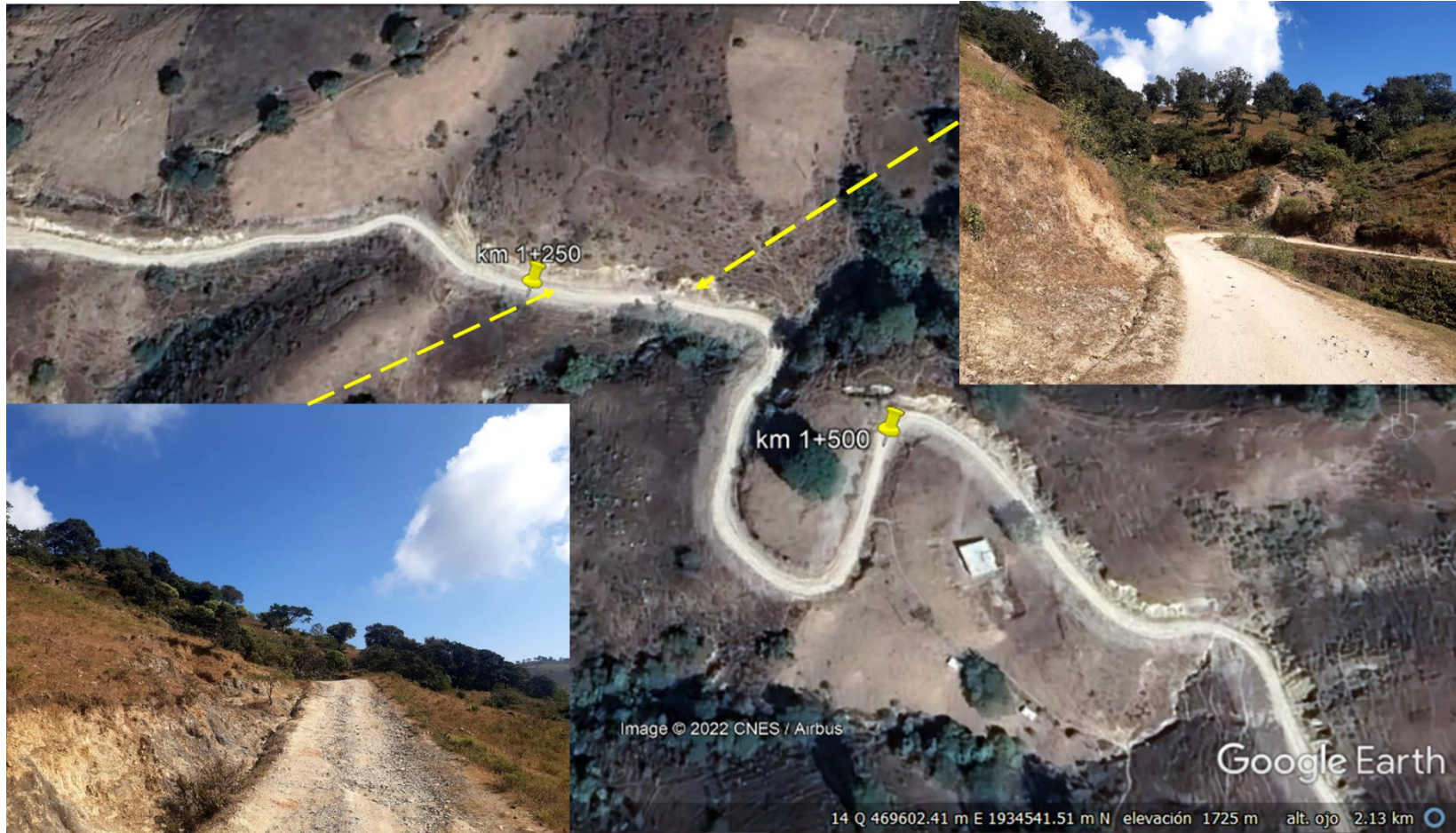
Ilustración 78.- Imagen satelital del tramo km 1+250 al km 1+500, donde el uso de suelo es agricultura de temporal anual con un ancho camino de 5.1 a 6.5 metros con especies aisladas de bosque de encino y selva baja caducifolia en los costados del camino.
