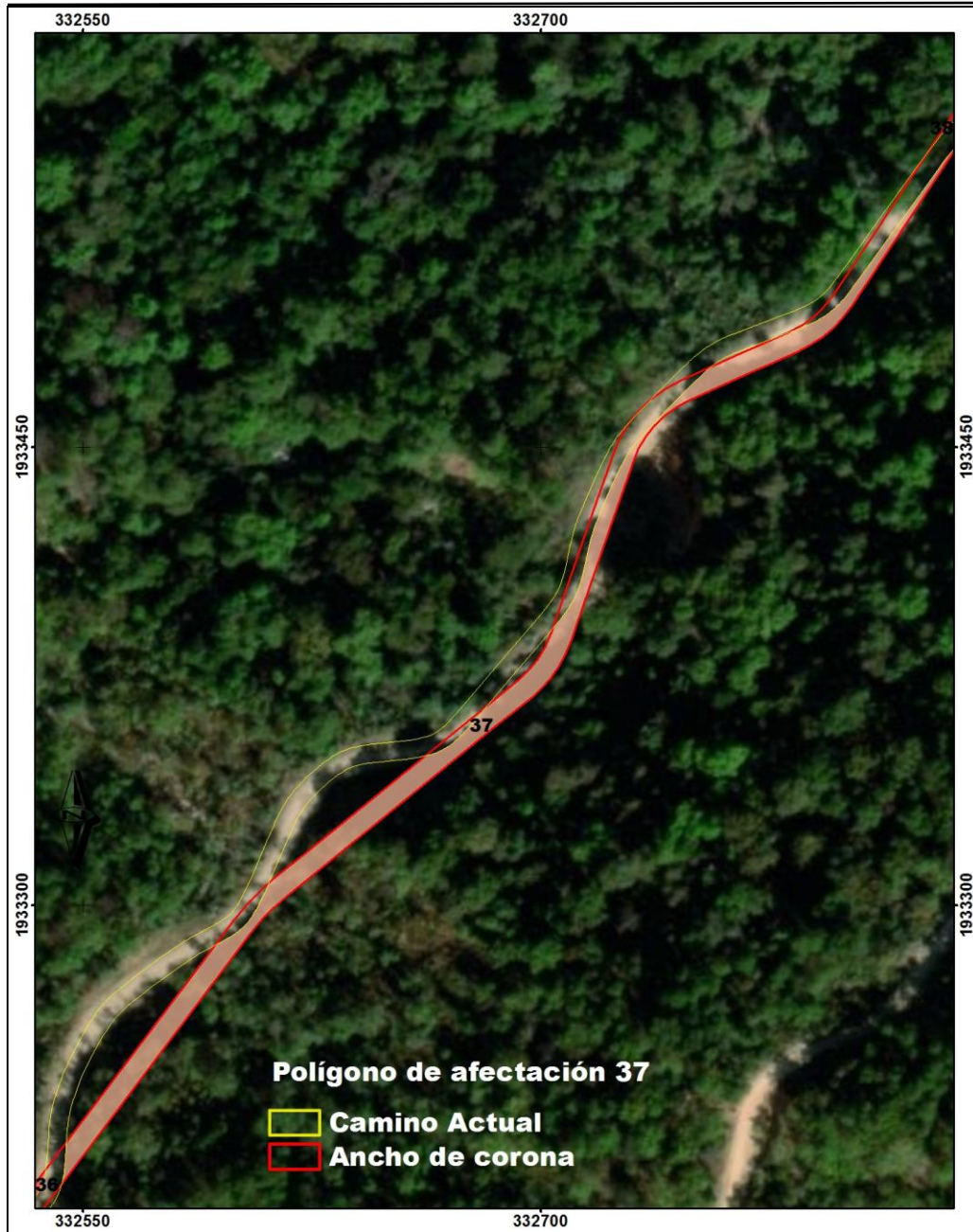
Ilustración 16. Polígono de afectación 37
