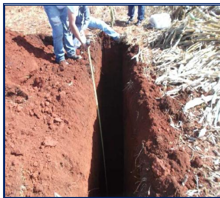
Muestreo de Materiales de Pozo a Cielo abierto (Estudio de Mecánica de Suelo, Predio El Cabrito)
