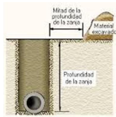
FIGURA II. 7 EXCAVACIÓN DE ZANJAS TIPO PARA LA TUBERIA DE CONEXIÓN
