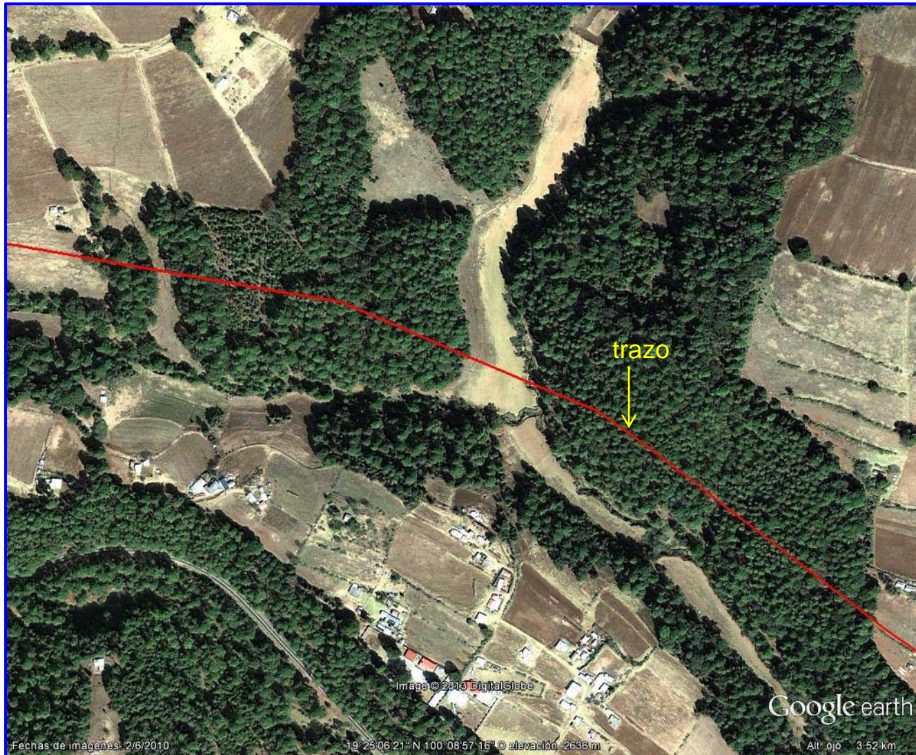
FIGURA IV.2.8.11. SE APRECIA QUE ENTRE EL KM 48+429 Y 49+541 HAY UN CAUCE DE UN ARROYO Y VEGETACIÓN RIPARIA
