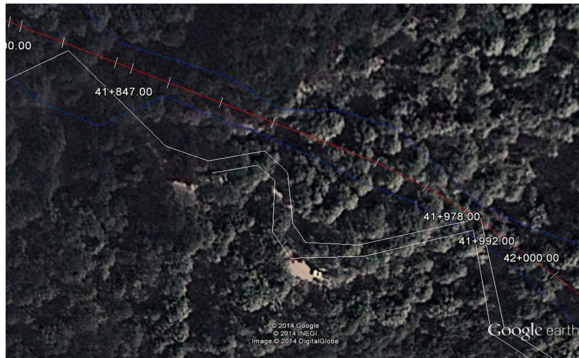
Figura 71. Rectificación del camino subtramo km 41+847 al 41+978.
