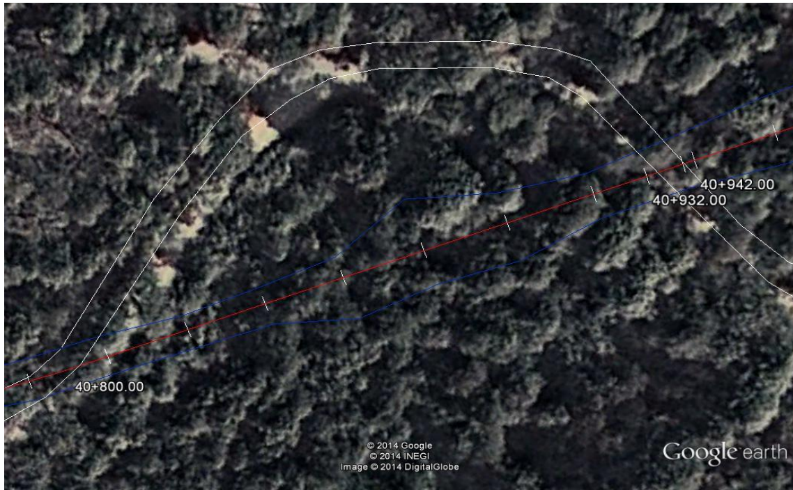
Figura 69. Rectificación del camino subtramo km 40+942 al 41+035.
