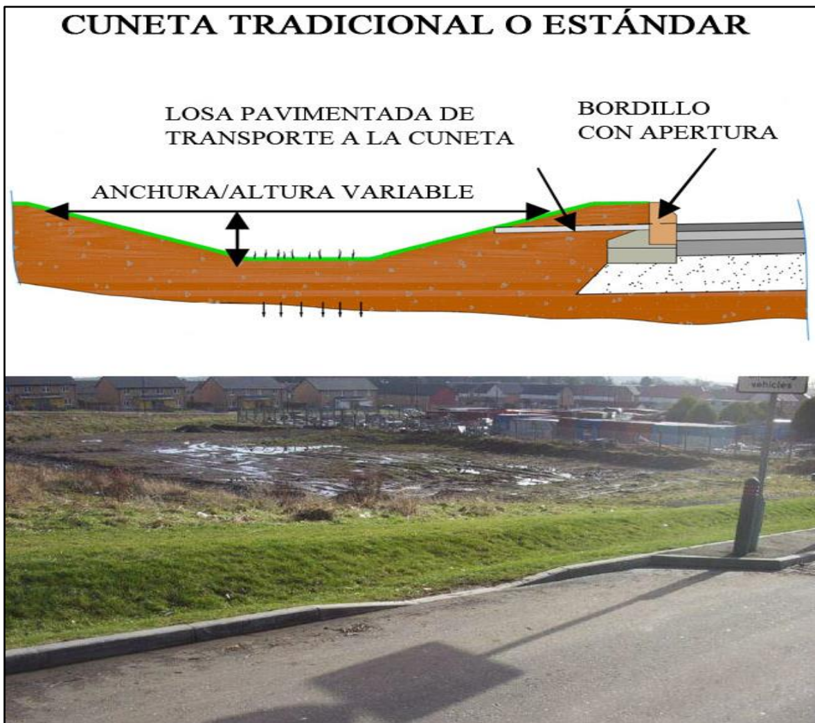
Figura No.14. Carretera con obras de drenaje secundaria, cunetas.
