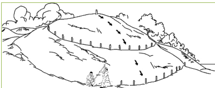
Figura 6.6. Trazado de acuerdo a las curvas de nivel.
