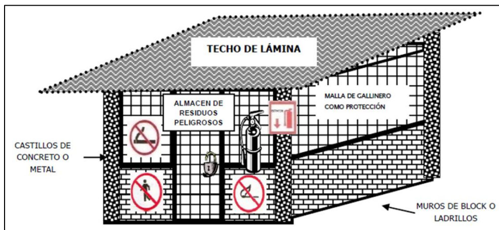
Figura 2.17. Características del almacén de residuos y sustancias peligrosas.
