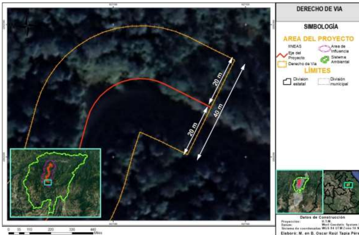
Figura 29. Superficie del Predio (derecho de vía del proyecto).
