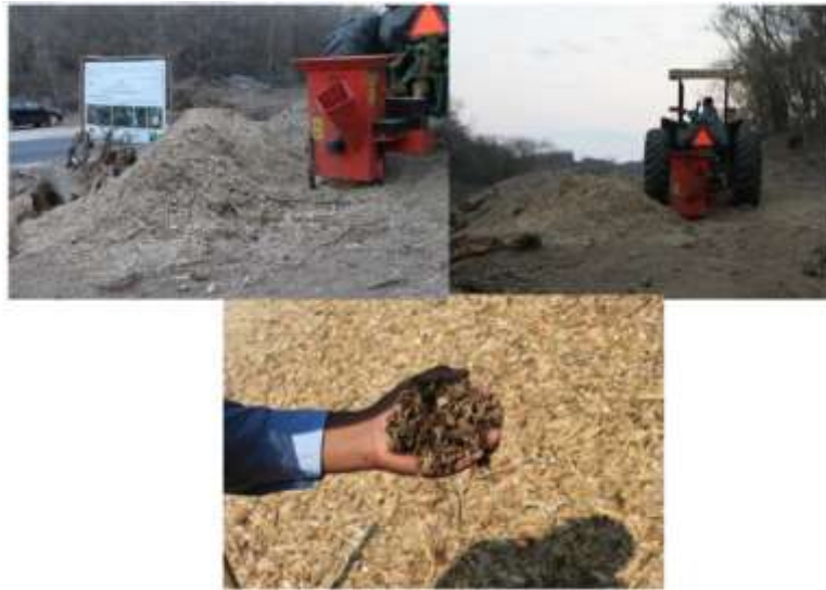
Figura 6. Ejemplo de la trituración y Composteo de material resultado del desmonte y despalle
