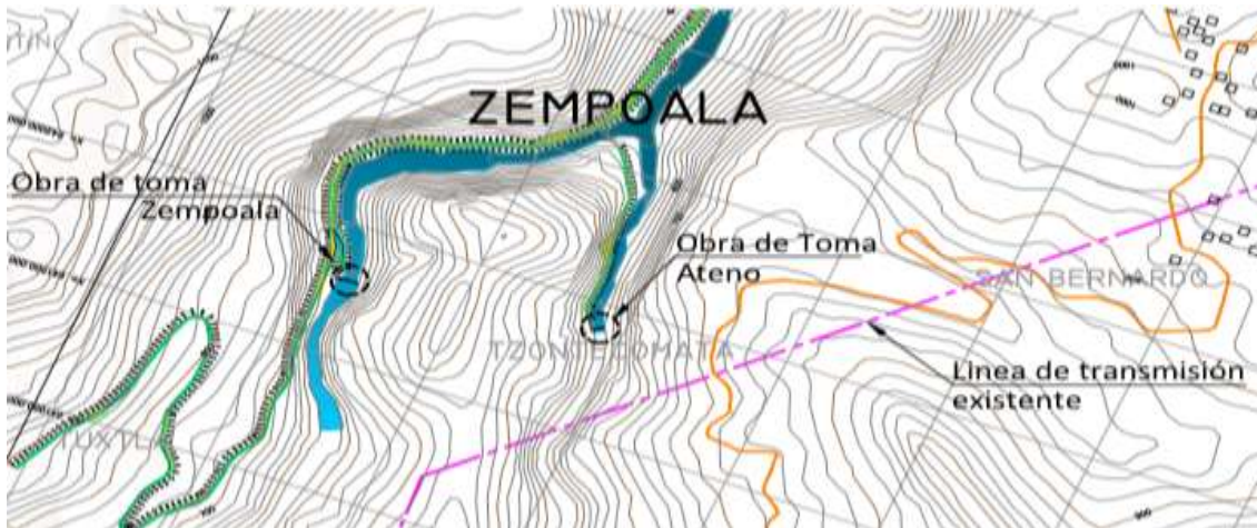
Diagrama de planta de las obras de toma propuestas y su relación respecto a los Ríos Zempoala y Ateno
