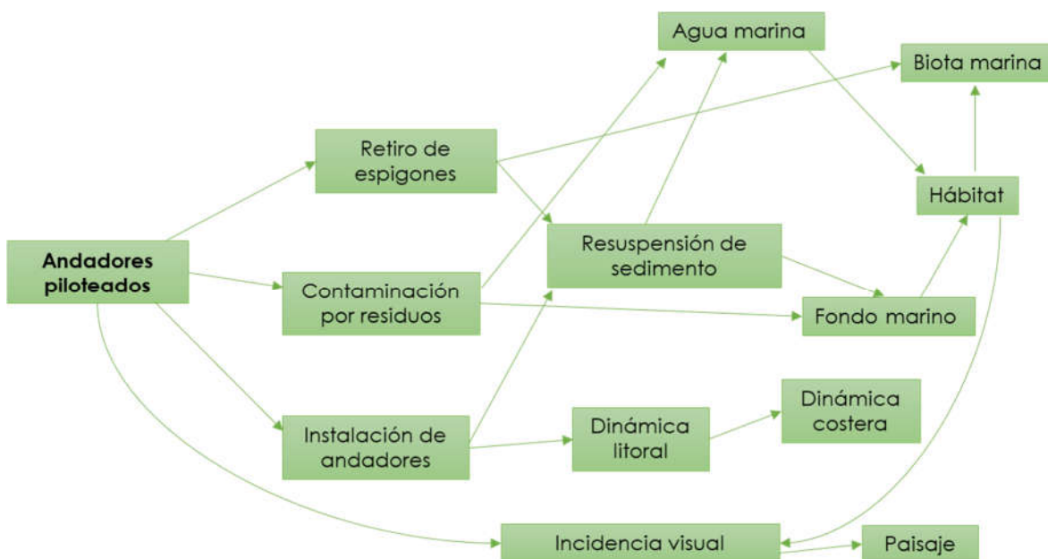
Figura 12. Grafo de relación causa-efecto que muestra los posibles efectos por la instalación de andadores piloteados.
