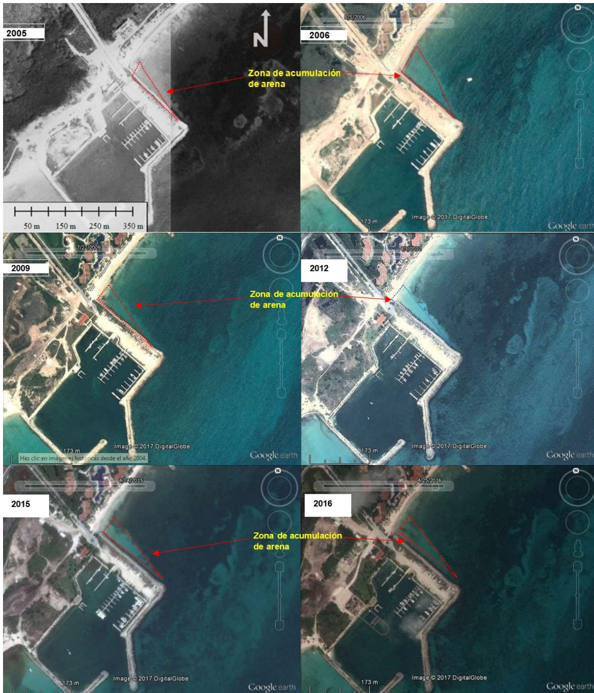
Figura 29. Zona de acumulación de arena “A” (Banco A) en el periodo comprendido entre los años 2005 a 2016.
