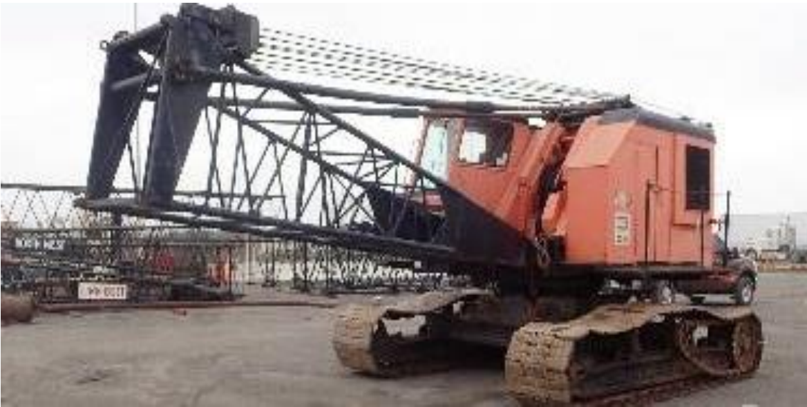
Figura 14. Ejemplo de grúa Northwest de 60 toneladas para el traslado de las piezas.
