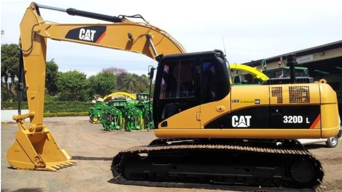
Figura 22. Ejemplo de retroexcavadora hidráulica que se usará para el retiro de espigones.
