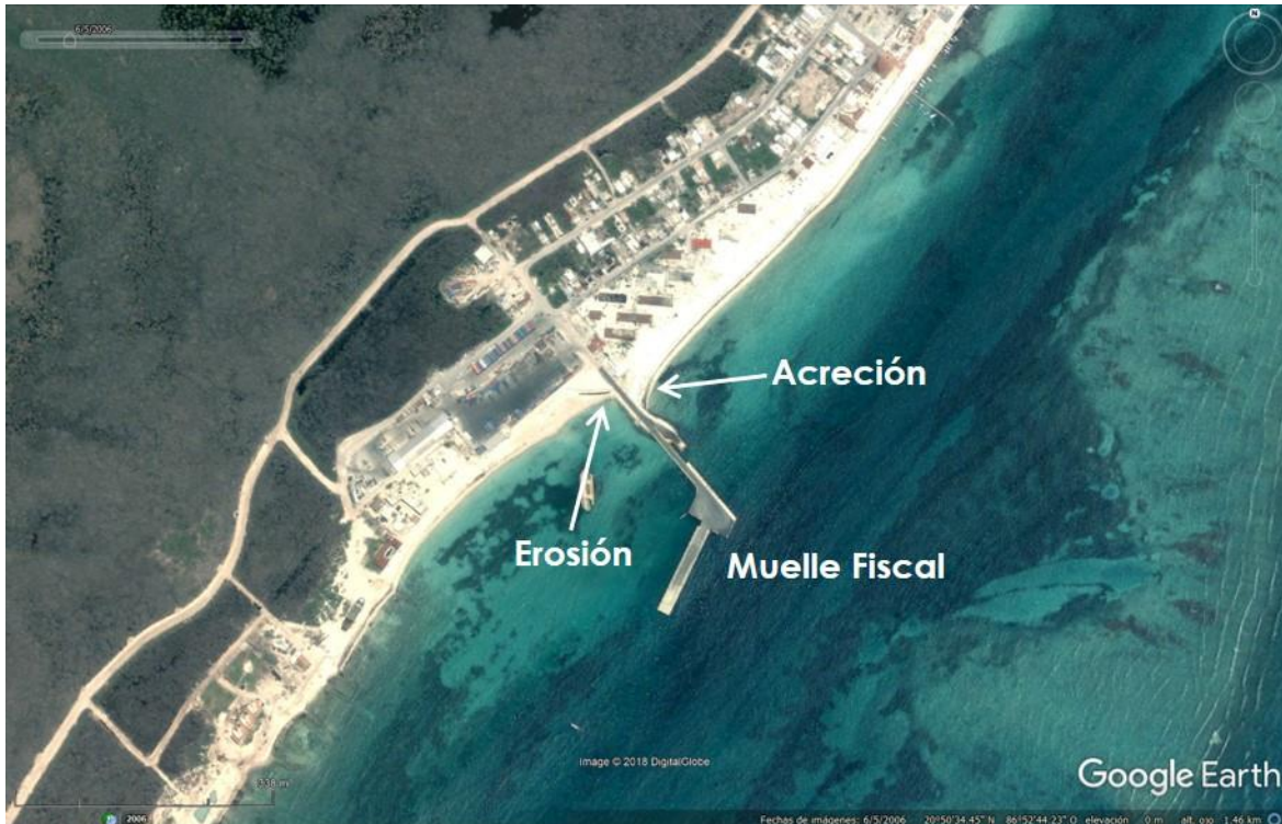
Figura 31. Vista satelital que muestra la erosión y acreción de la playa producida por la presencia del Muelle Fiscal. Fuente: Google Earth (2006).
