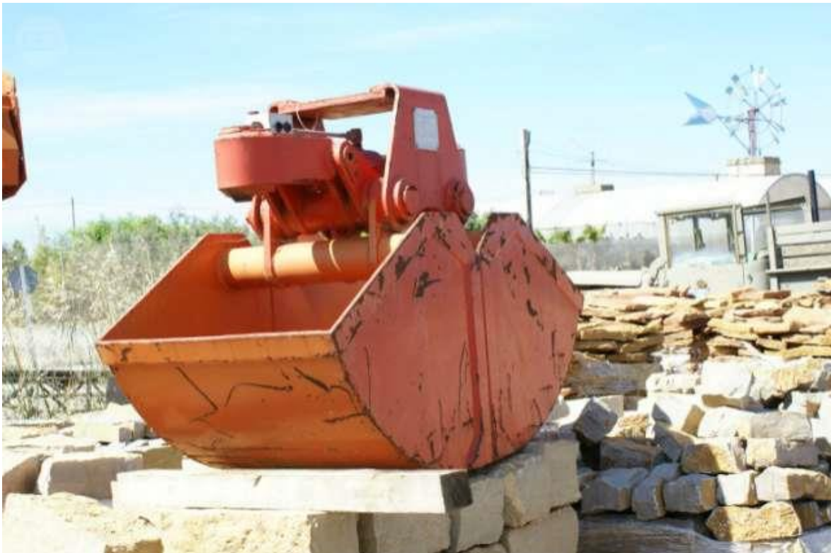
Figura 19. Ejemplo de pala almeja que podrá ser usada para la colocación de las piezas.
