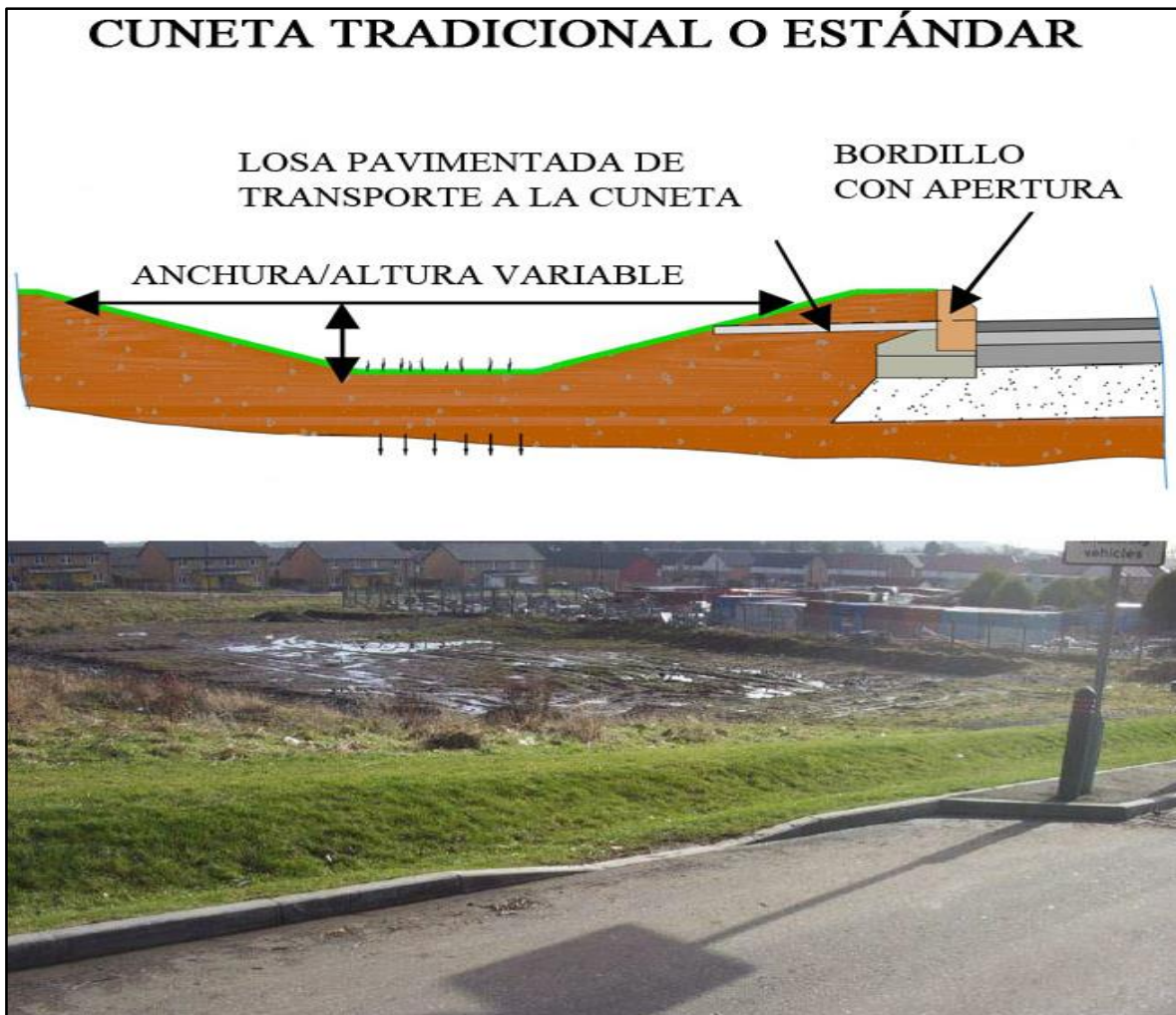
Figura No. 23. Carretera con obras de drenaje secundaria, cunetas.
