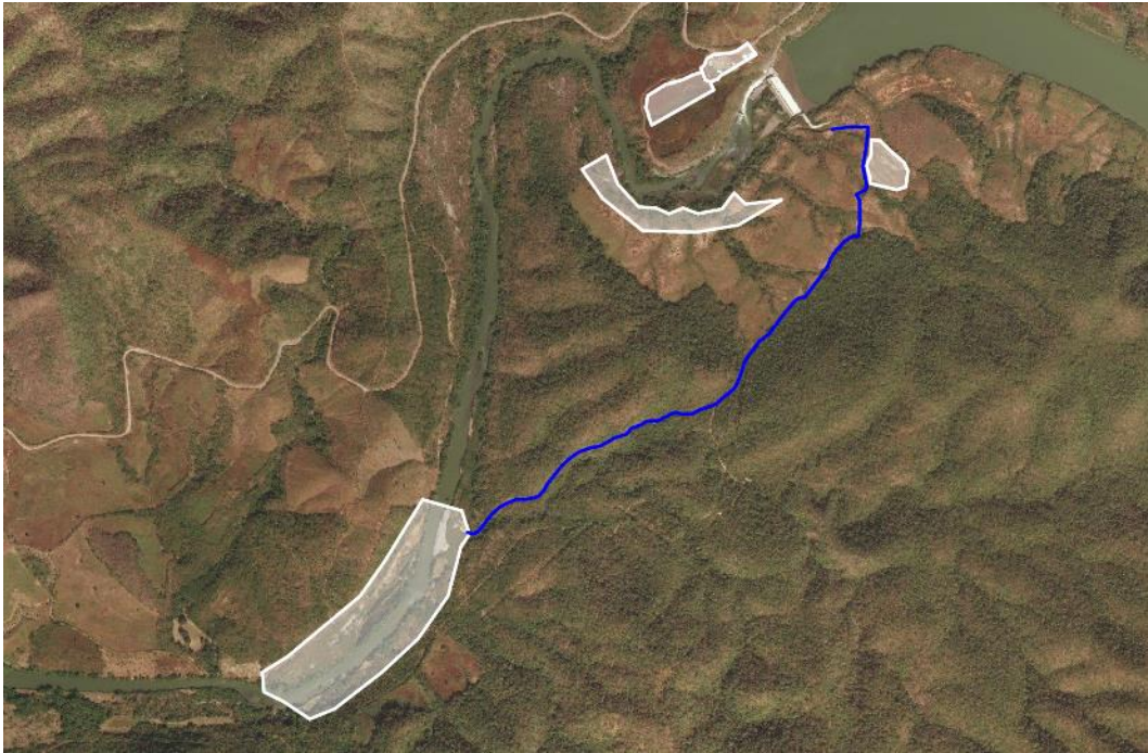
Figura II-74. Camino de acceso provisional al banco de materiales
