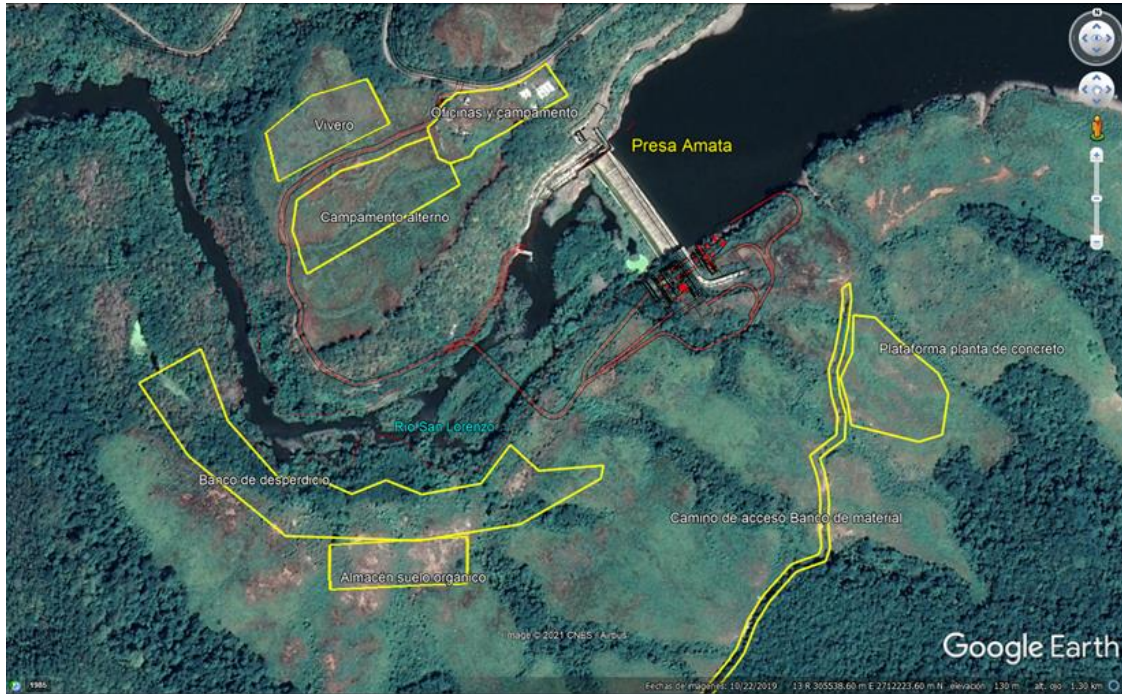
Figura VII-5 Polígonos que contienen obras temporales para el PEH Amata, y que se ubican sobre un uso de suelo agrícola anual de temporal en su mayor parte.
