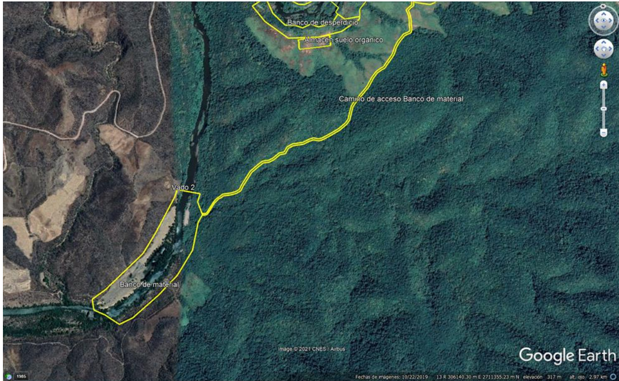
Figura VII-6 Polígonos de uso temporal en la margen izquierda, que corresponden al camino de acceso al banco de material, el banco de material y un vado que será construido para la explotación del banco por la margen derecha.
