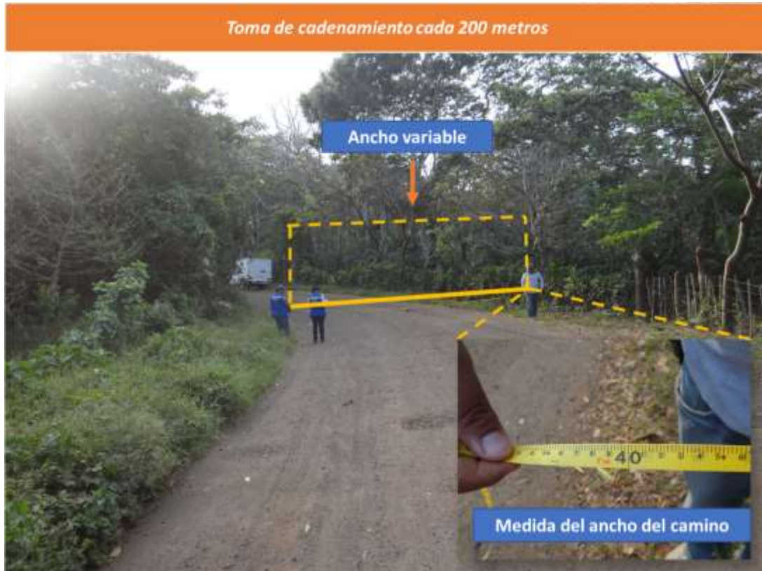
Figura 4. Toma de cadenamiento cada 200 m
