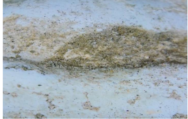
(صورة ١٤-أ) توضح تأثير الأملاح علي الجبس والشروخ والتقشر والفقد لبعض الاجزاء. باستخدام Wireless USB Microscope X800 © تصوير الباحث.
