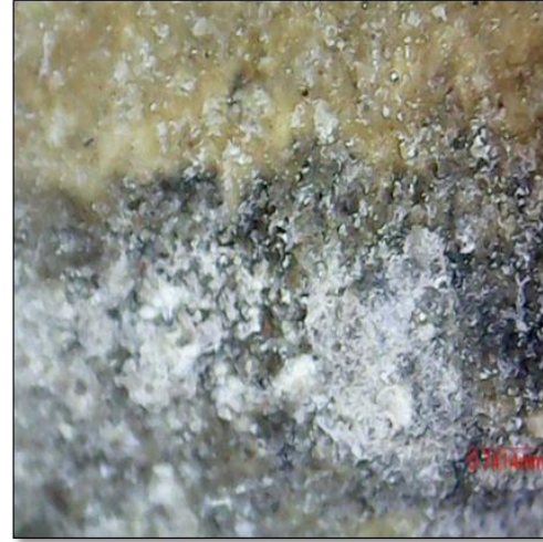
(صورة ٤) تمثل صورة بالمجهر الرقمي بقوة تكبير 1, (صورة ٤) لجزء من العينة توضح الأملاح المتبلورة على السطح ©تصوير الباحث
