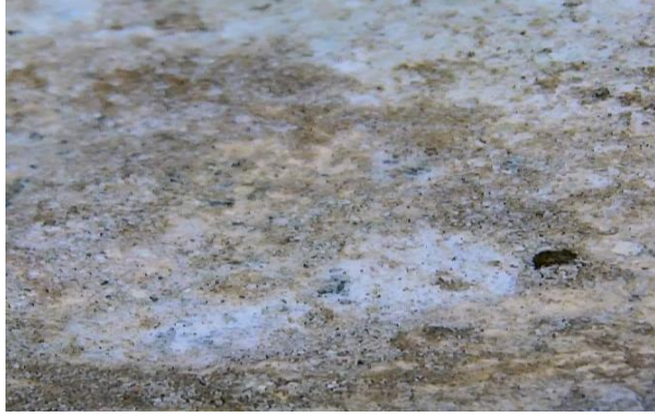
(صورة ١٤-ب) توضح الفقد والتقشر وتراكم الاتساخات والتصاقها بالسطح لتشوه المنظر. باستخدام Wireless USB Microscope X800 © تصوير الباحث.
