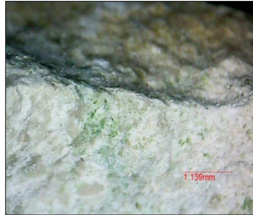
(صورة ٦) تمثل صورة بالمجهر الرقمي بقوة تكبير (1, 139MM) لجزء من العينة توضح نمو الكائنات الحية الدقيقة ©تصوير الباحث
