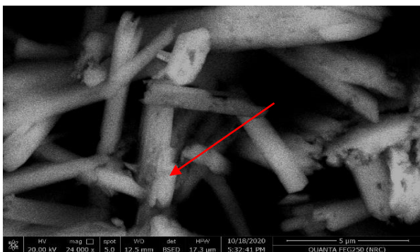
(صورة ١٢) توضح عينة من الشبائيك الجصي أعلى الباب يظهر الجبس تحت الميكروسكوب الإلكتروني الماسح 4000x يتضح تدهور البلورات المعدنية وظهور الأملاح البلورية.
