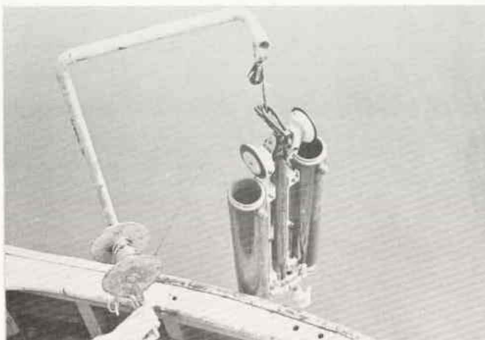
Fig. 19 : Bouteille à clapets. Modèle MONZIKOFF (contenance 2 x 5 l).
