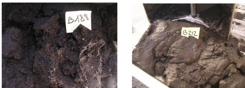
Figure 3 : Photographies de prélèvements de sédiments à la benne Van Veen portant le n° de l'échantillon
