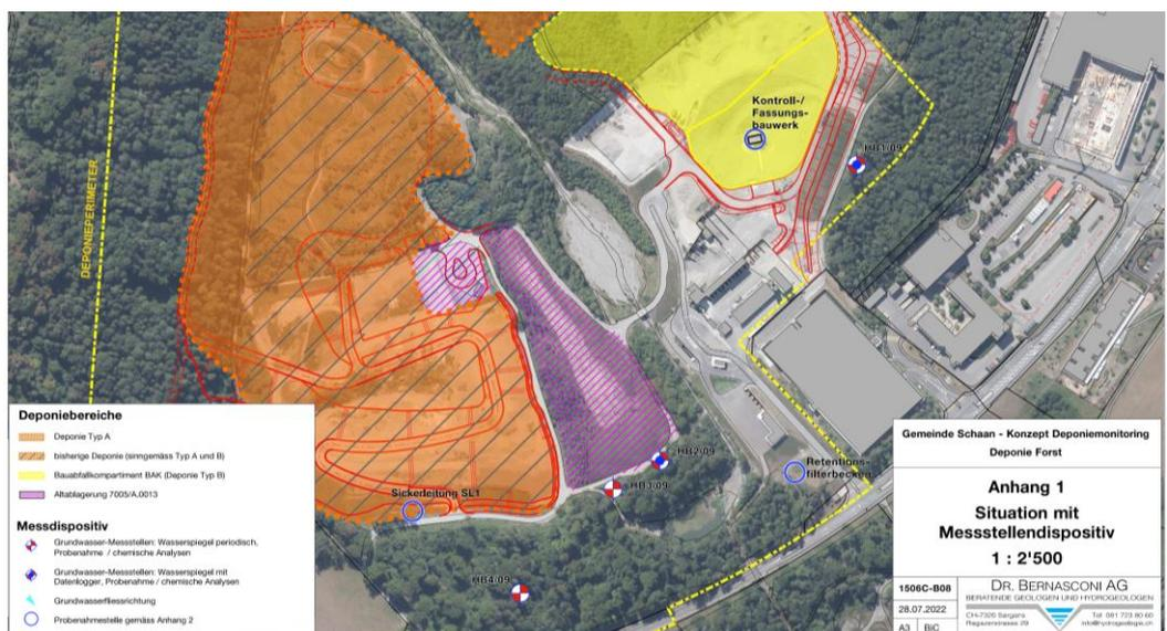
Abbildung 4: Planausschnitt aus Bericht 1506-B08 - Situation mit Messstellendispositiv, Monitoring Entwässerung und Grundwasser – Überwachungskonzept, Dr. Bernasconi AG, 2022.
