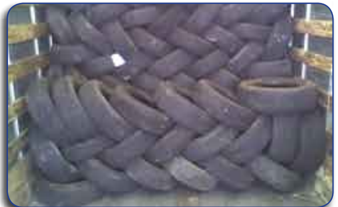
Técnica correcta de intercalado para el transporte de llantas Foto cortesía de Tire Recycling and Disposal, Inc.
