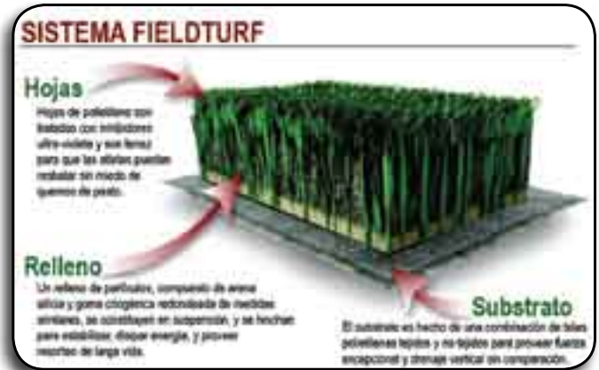
Figura 3-2. Corte transversal del pasto Field Turf. Foto cortesía de FieldTurf Tarkett.
