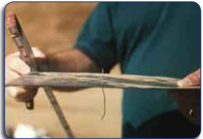
Figura 5-3. Ejemplo de alambre de talón que perfora la geomembrana (Ref. 12).
