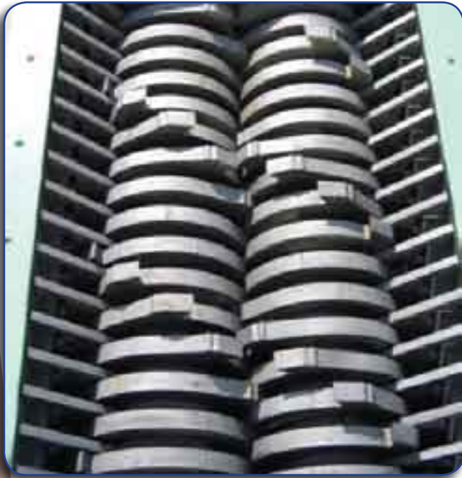
Trituradora con cuchilla de gancho. Foto cortesía de Granutech Saturn Systems Corporation, Dallass, TX
